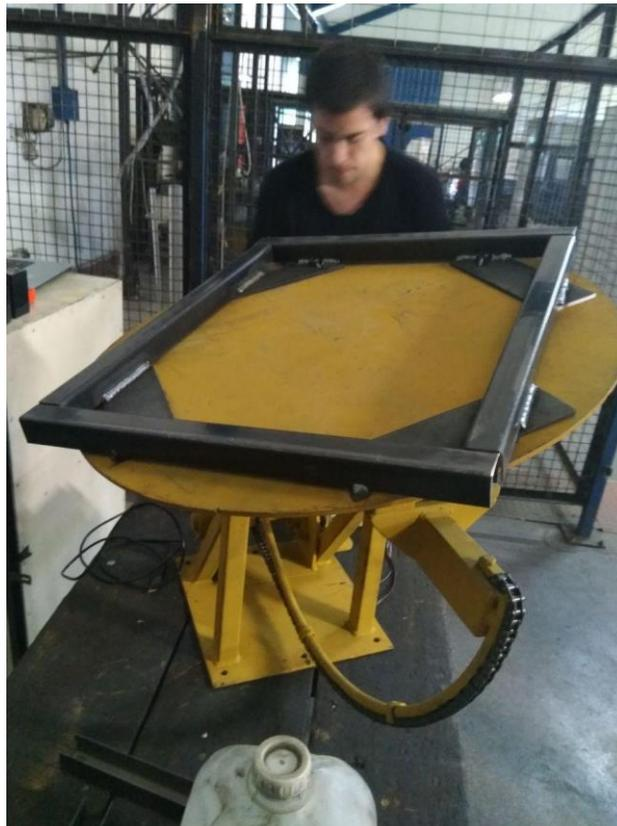
**Figura 42:** Fabricación e instalación de marco para espejo de 1[m<sup>2</sup>] para Prototipo 2.0.
