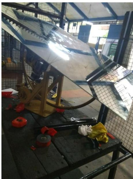
**Figura 43:** Espejo OptiWhite ya instalado en Prototipo 2.0.
