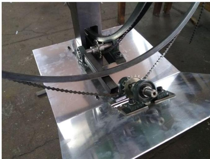
**Figura 25:** Sistema de transmisión mecánica Prototipo 1.0.
