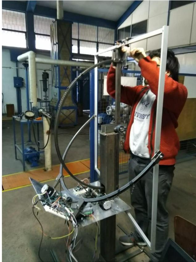
**Figura 28:** Pruebas de funcionamiento con ambos ejes simultáneos Prototipo 1.0.
