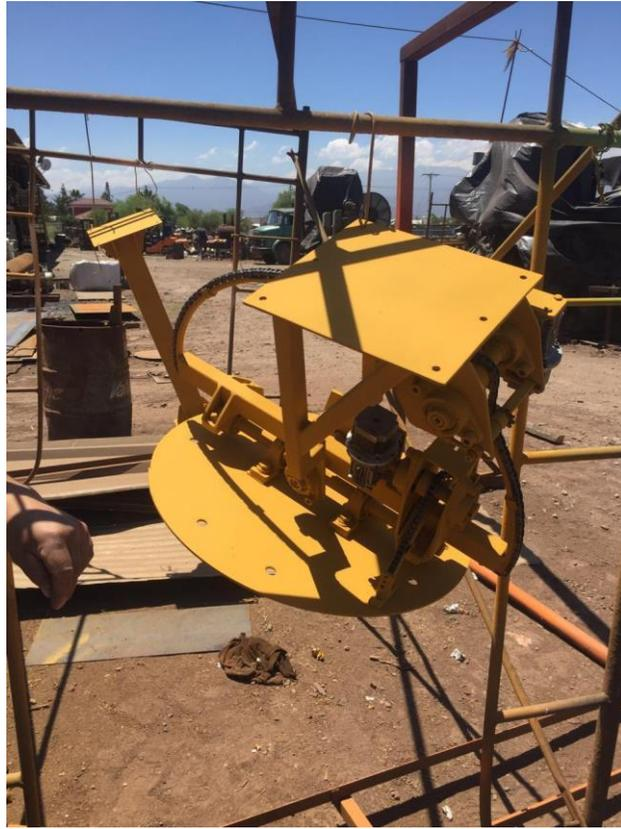
**Figura 40:** Etapa de aplicación de pintura anticorrosiva Prototipo 2.0.
