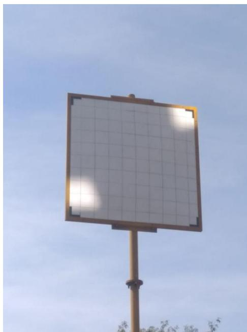
**Figura 33:** Plancha objetivo para pruebas de reflexión Prototipo 1.0.
