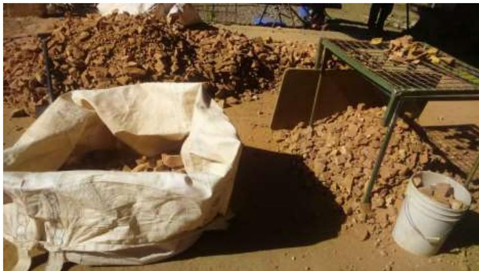
Figura 3.10: Parte de una macrogranulometría, material bajo 3" pasa por criba de tamaño nominal de 2 ½".
