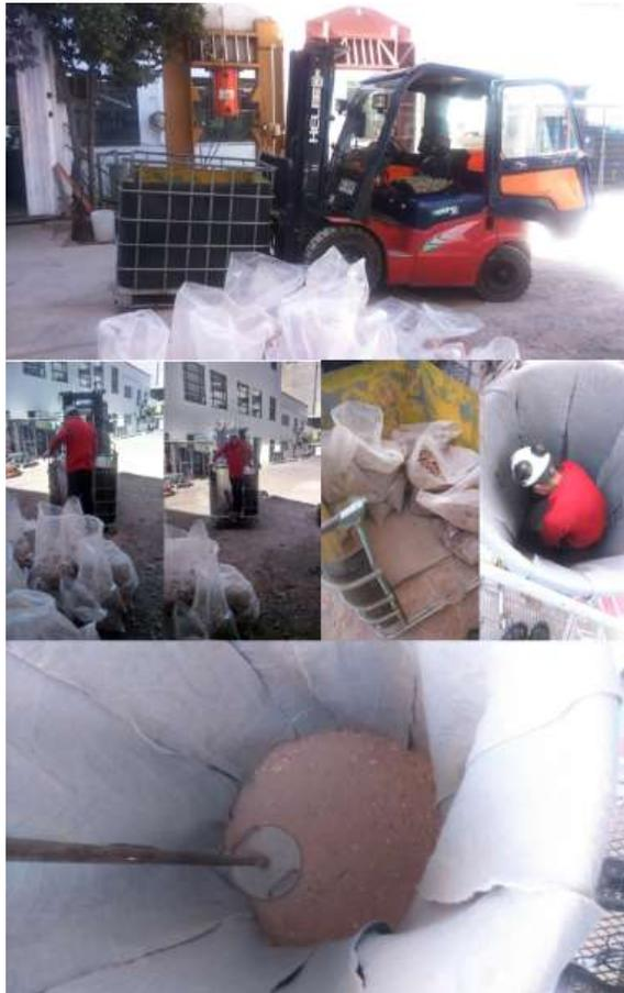
Figura 3.8: Proceso de armado de la probeta, en capa 2/6.
