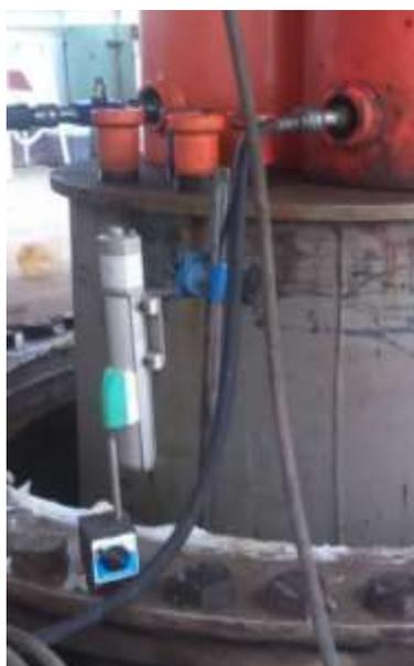
Figura 3.7: Sensor de Desplazamiento de tipo LVDT.
