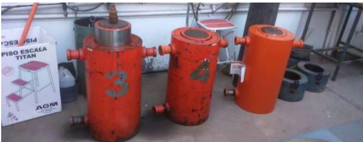
Figura 3.6: Cilindros hidráulicos para carga axial.
