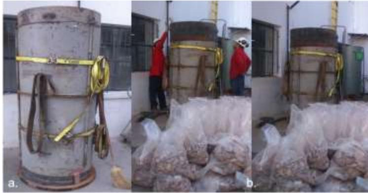
Figura 3.3: a. Molde dimensiones 100x180 cm. b. Posicionamiento de membrana.
