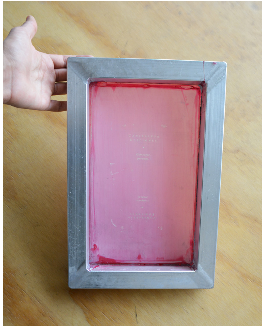
| Bastidor serigráfico ya emulsionado y quemado.
