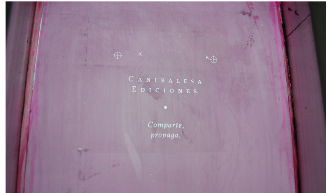
| Bastidor serigráfico ya emulsionado y quemado.
