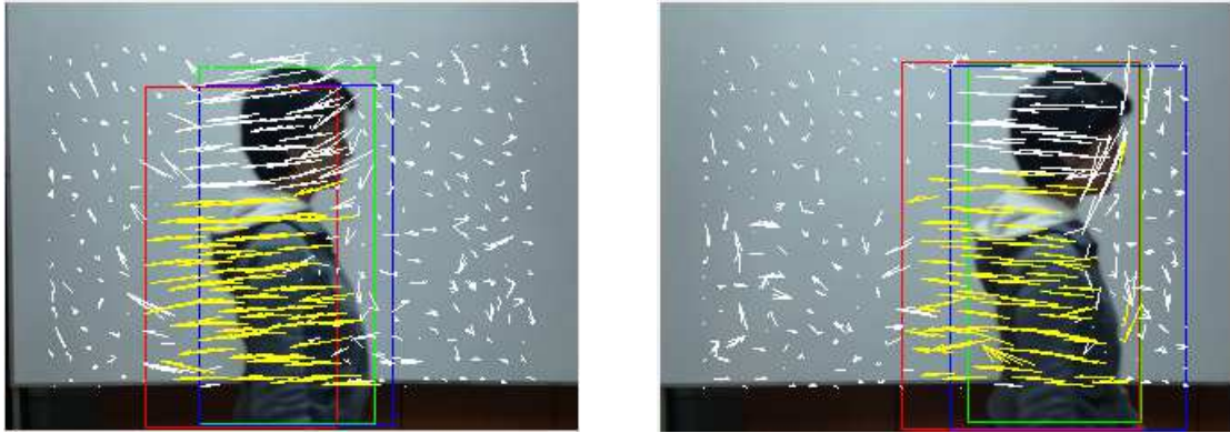
Figura 15: Ejemplo de la detección delay-free. Las imágenes de izquierda a derecha representan detecciones de imágenes consecutivas, con diferentes tracks de características calculados. La etiqueta de la posición real del objeto GT (ground-truth) está representado por el recuadro verde. El retraso de la detección está representado por el recuadro rojo. La detección libre de retardo está representada por el recuadro azul. Los tracks de características se visualizan como líneas en la imagen. Los tracks de características aceptados por RANSAC y usados para calcular la transformación libre de retardo (delay-free) se visualizan en líneas amarillas.
