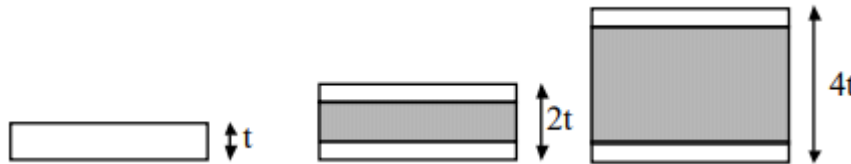
Figura 1.3: Comparación entre rigidez y peso en estructura tipo sándwich
