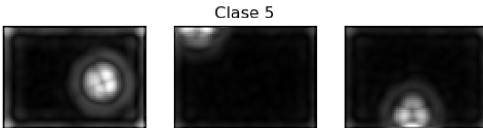
Figura 3.7: Imagen con daño de delaminación, clase 5
