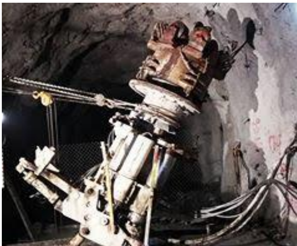
Ilustración 2-8 Equipo Blind Hole para desarrollo vertical
