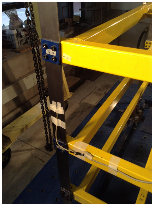
(a) Montaje de Sensor T1 en columna
