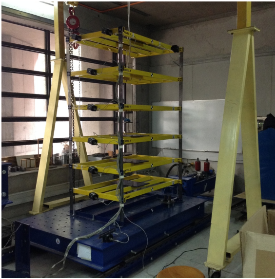
(a) Imagen de Estructura Monitoreada sobre mesa vibradora
