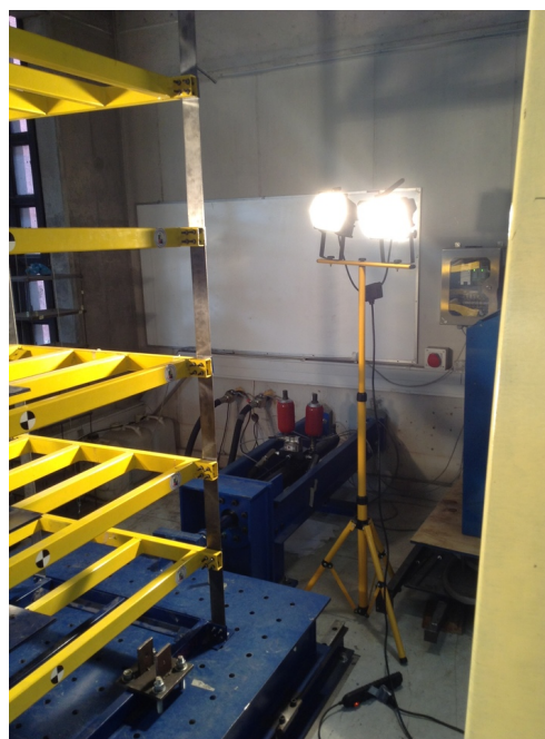
(b) Aplicación de Anomalía por Aplicación de Gradiente de Temperatura con Reflectores
