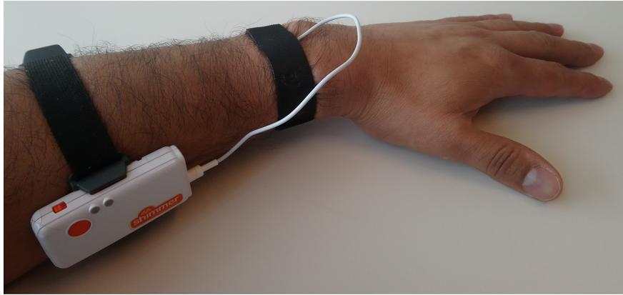
Figura 4.11: Posición del sensor óptico para mediciones de PPG, en la muñeca izquierda. (Fuente: Elaboración propia)
