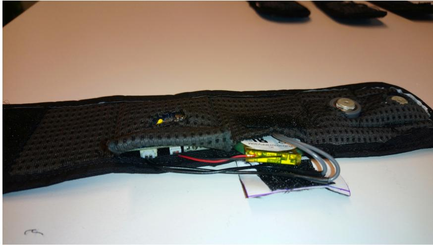
Figura 4.2: Bolsillos internos para portar placa y batería. (Fuente: Elaboración propia)
