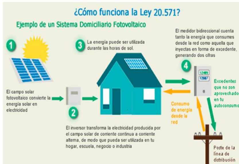
Figura 2.10: Esquema de funcionamiento de un sistema Net-Billing. Fuente: SEC
