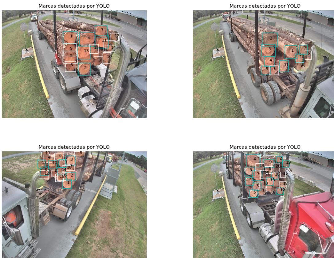
Figura 3.13: Ejemplo de detecciones, para la red seleccionada, con menor Recall
