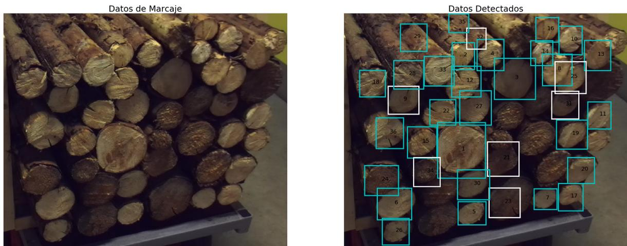
Figura 3.15: Ejemplo de detecciones, para la red seleccionada, con imágenes fuera de la base de datos
