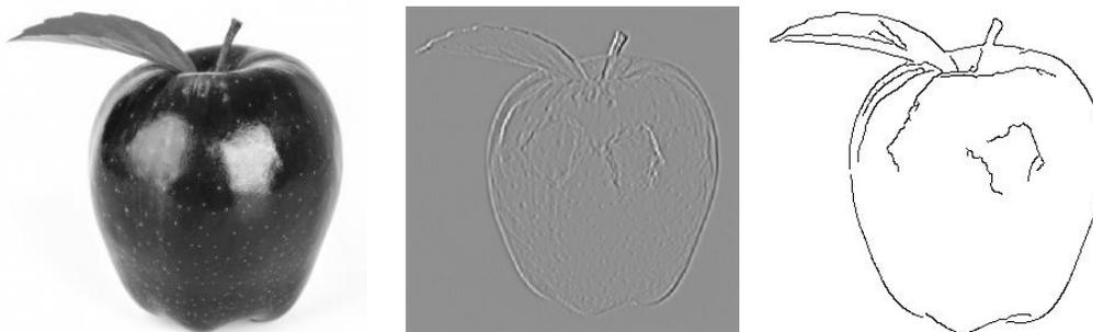
Figura 1.13: Detector de bordes Canny: Imagen en escala de grises (izq), operador de bordes de Sobel (centro) y el resultado de aplicar el operador de bordes Canny (der)
