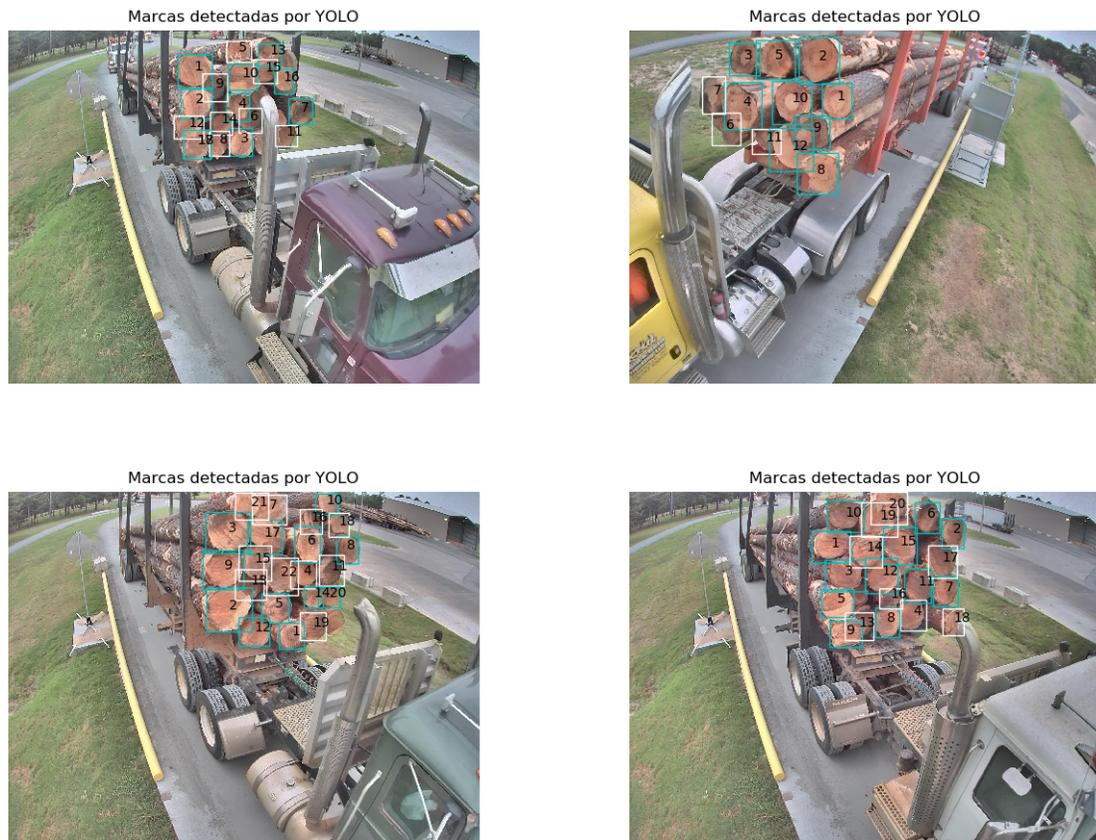
Figura 3.12: Ejemplo de detecciones, para la red seleccionada, con mejor Recall
