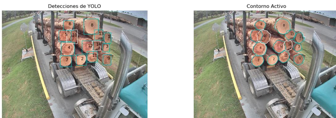
Figura 3.25: Detecciones de YOLO (izq) y Filtro uno (der) para imagen de ejemplo
