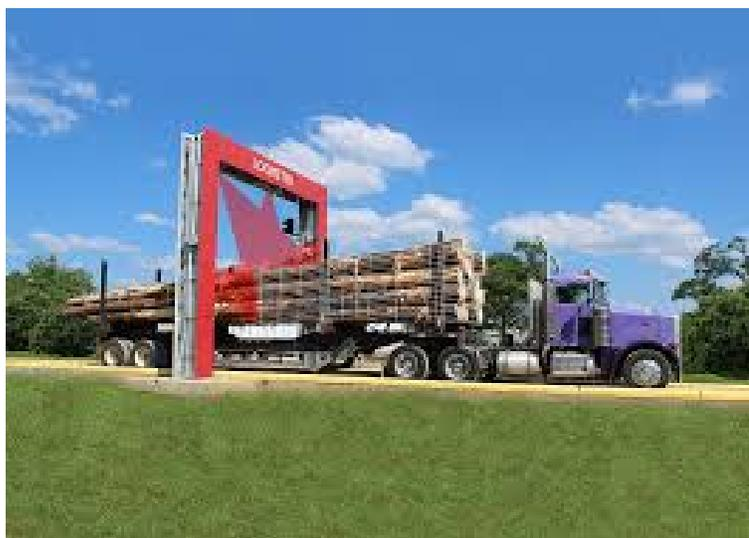
Figura 2: Sistema de medición de volumen de madera, Logmeter
