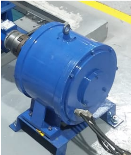
Figura 3.8: Generador a utilizar en el proyecto.
