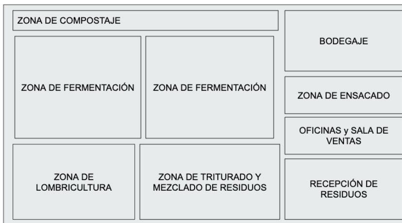
Figura 16. Diseño espacial general de la planta (Fuente: Elaboración Propia).
