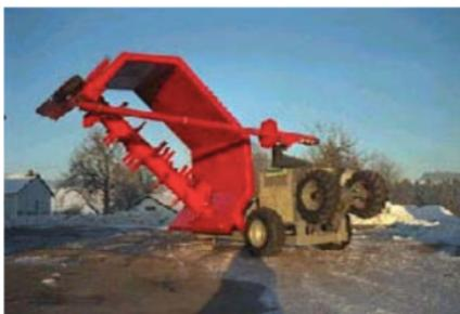
Figura 31. Máquina de volteo Sandberger (Fuente: Montero J., 2006, p.44).
