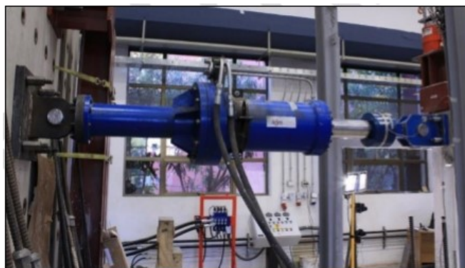
Figura 4.6: Actuador hidráulico utilizado en la aplicación de carga lateral. (ACMA, 2018)
