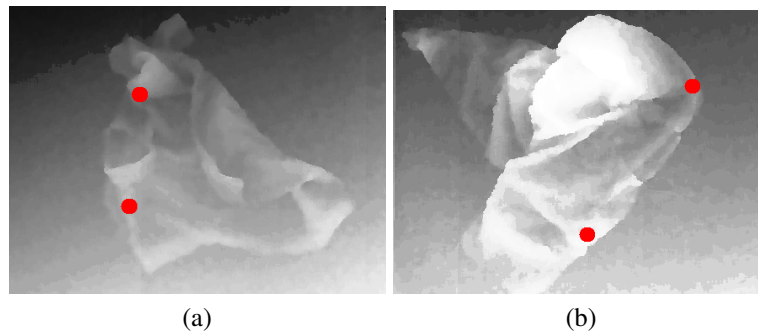
Figura 3.10: Selección final de puntos de agarre de la clase Shirt y T-Shirt . Fuente: Elaboración propia.
