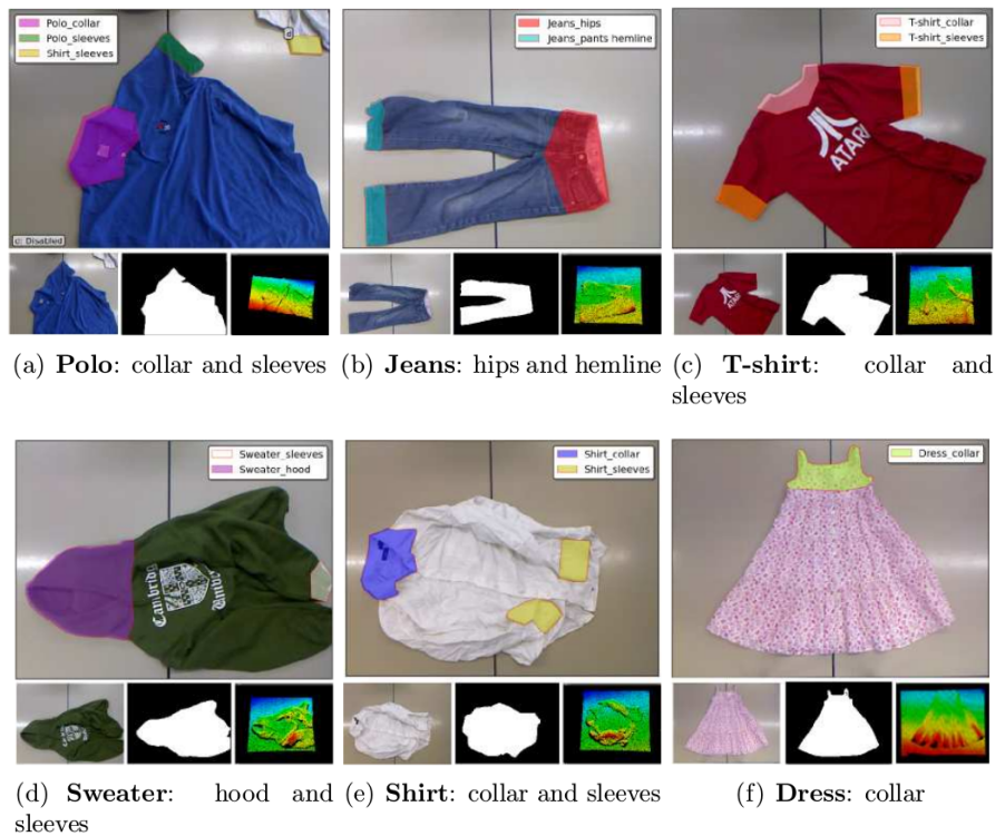
Figura 2.3: Ejemplos de detección de partes claves. En las imágenes se puede observar: anotaciones superpuestas (arriba), imagen original (parte inferior izquierda), máscara de segmentación (parte inferior central) y una representación de la información de profundidad (parte inferior derecho). Fuente: Ramisa et al., 2014 [53].
