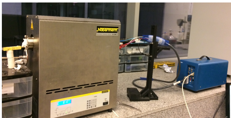
Figura 4.18: Montaje experimental para las mediciones de EIS en la celda simétrica (PBSCF|GDC|PBSCF).
