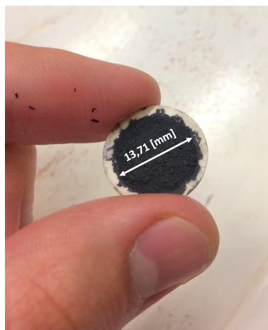
Figura 4.16: Imagen de la celda simétrica fabricada (PBSCF|GDC|PBSCF).
