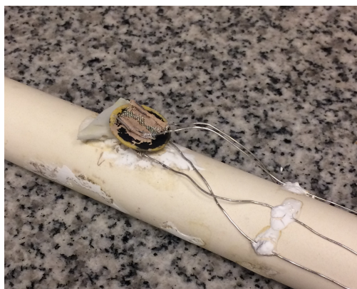
Figura 4.17: Montaje de la celda simétrica en el tubo de alúmina y conexiones electrodos-malla-cables.
