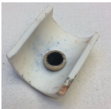
Figura 4.19: Imagen de la celda simétrica PBSCF|SDC|PBSCF, con muestra de PBSCF con 6 g de NaOH y calcinada a 900 [°C].
