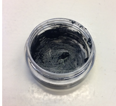
Figura 4.15: Pintura de PBSCF utilizada para la fabricación de la celda simétrica.
