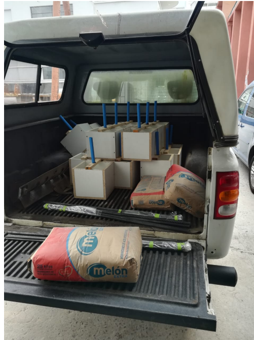
Figura 3.8: Transporte de materiales y moldes de probetas de adherencia
