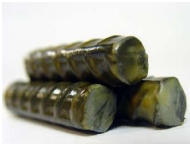
Figura 3.2: Imagen referencial de barras con pintura MCI
