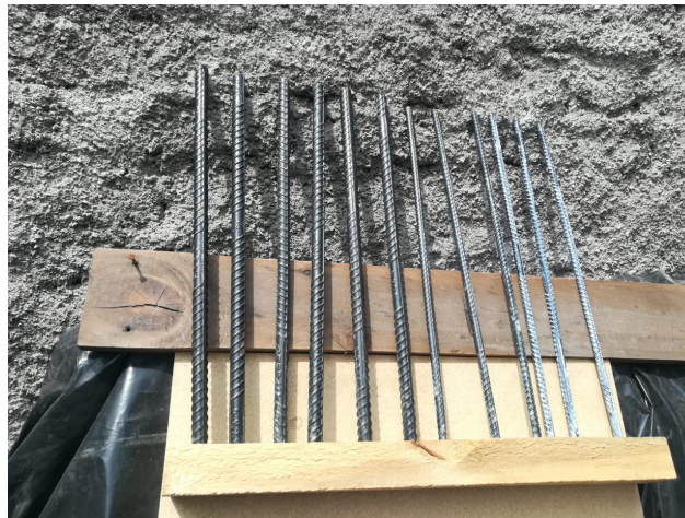
Figura 3.3: Barras de corrosión acelerada (CA) y adherencia (AD), pintadas con MCI
