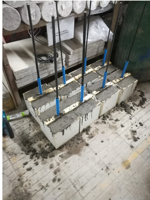
Figura 3.9: hormigonado de probetas
