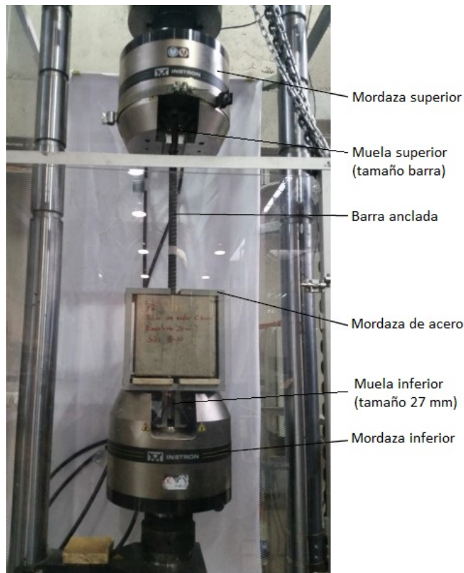
Figura 3.13: Esquema de los ensayos de adherencia.
