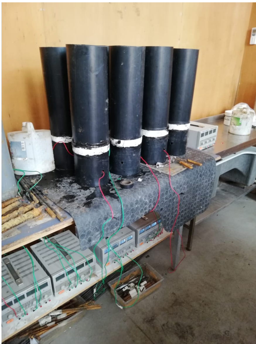
Figura 4.10: Inicio de corrosión simultaneo
