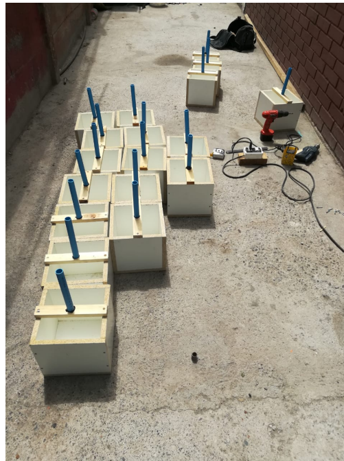
Figura 3.7: Moldes para probetas de adherencia
