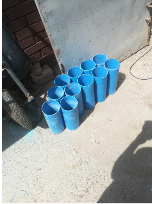
Figura 3.10: Moldes de corrosión acelerada (CA)
