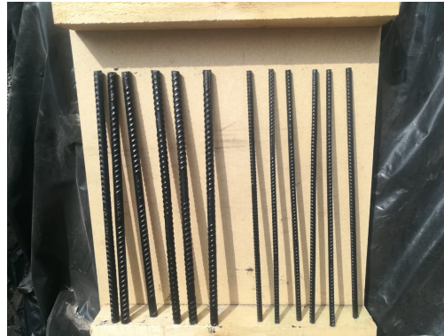
Figura 3.4: Barras de CA, pintadas con anticorrosivo de maestranza
