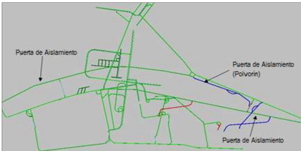
Figura A-7: Puertas para aislar avance de humo y gases para la situación actual
