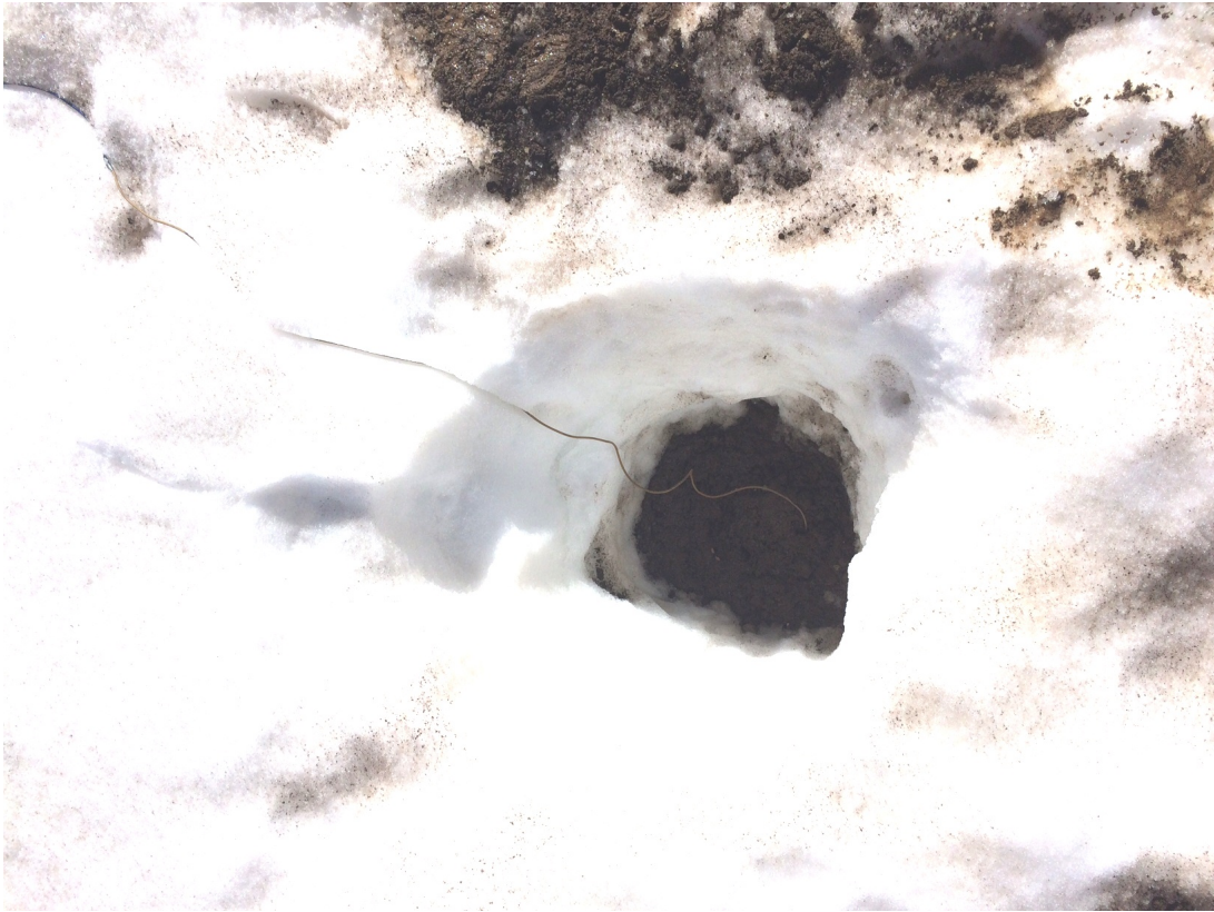
Figura 4.4: Muestra el electrodo enterrado bajo tierra con una capa de nieve encima, aparece en la foto el cable que lo conecta al equipo digitalizador ADU.
