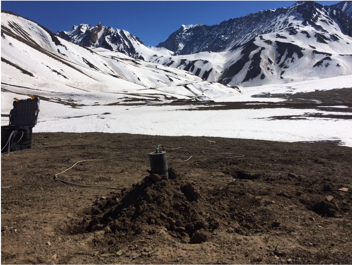
Figura 4.5: Muestra la bobina vertical instalada y la izquierda los cables saliendo del case donde va el digitalizador ADU que graba los datos
