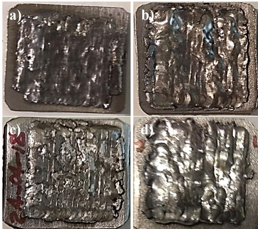
**Figura 3.4.** Morfología superficial de las multicapas obtenidas por Laser Cladding sobre cupones de acero inoxidable de 25 x 25 x 5 mm. (a) LCA-B0, (b) LCA-B3, (c) LCA-B5 y LCA-B10.
