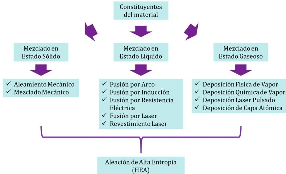
**Figura 1.29.** Ilustración de las rutas de fabricación de las aleaciones de alta entropía (HEAs), adaptada de [8].
