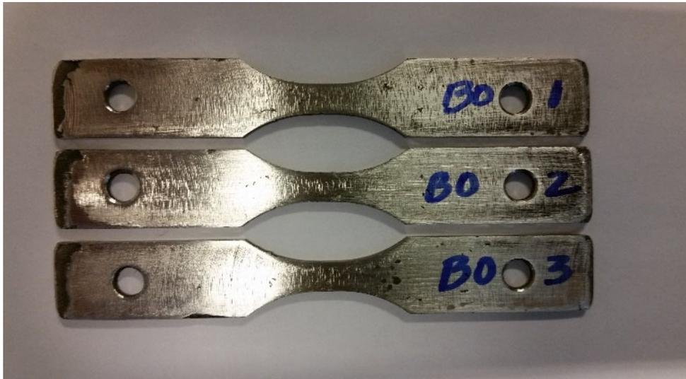
**Figura 3.5.** Muestras típicas producidas por Laser Cladding para ensayos de tensión.
