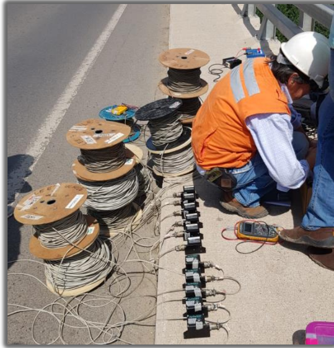
Figura 3-2: Acelerómetros utilizados durante la campaña de enero de 2019
