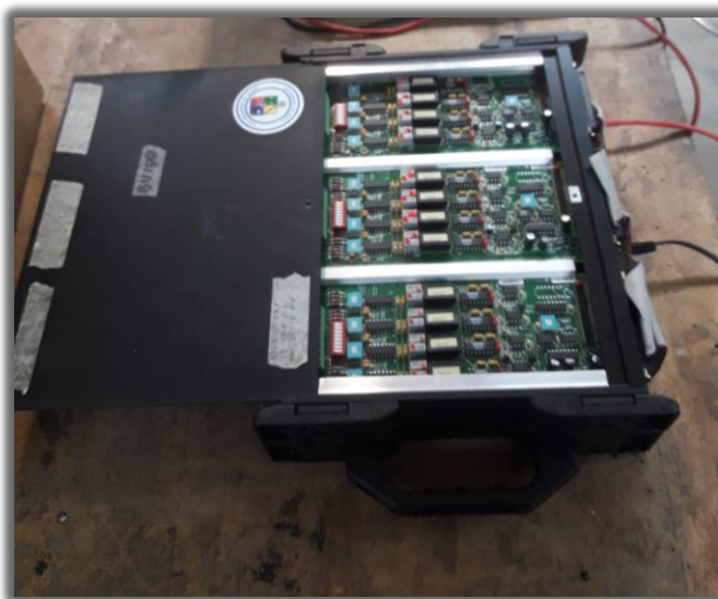
Figura 3-1: Equipo DAQBOOK/2005 utilizado en las mediciones
