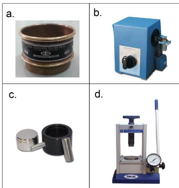
*Figura 3.5 Instrumentos utilizados en la fabricación de los discos de KBr. a. Malla número 200. b. Agitador Specamill. c. molde de la pastilla. d. Prensa hidráulica manual Specac (b, c y d fueron extraídos de la página de venta de Specac).*
