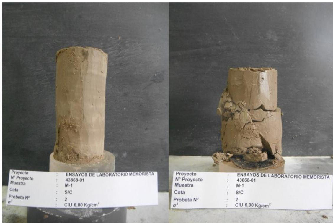
Figura 4.22 Imagen de la muestra antes y después de realizar el ensayo triaxial consolidado - no drenado, con una presión confinante de 6 kg/cm<sup>3</sup>, realizada a una probeta proveniente de la muestra SP1804.
