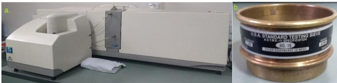
Figura 3.7. a. Granulómetro Laser Mastersizer 2000; a la izquierda de la foto se observa el equipo Hydro G.
