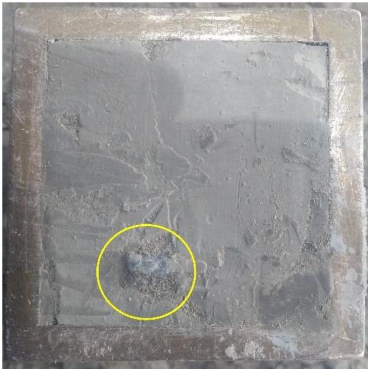
Figura 4.15 Imagen que muestra uno de los testigos de la muestra SP1804 inserto en el molde. Se destaca con una circunferencia amarilla el clasto de mayor tamaño.
