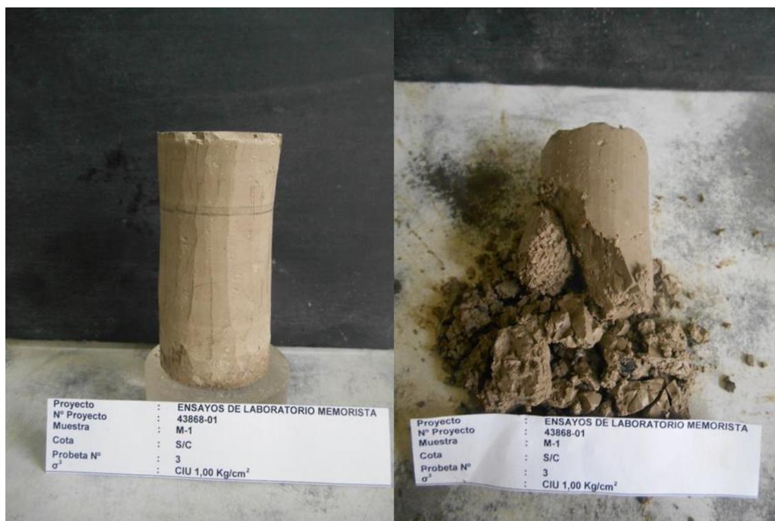
Figura 4.20 Imagen de la muestra antes y después de realizar el ensayo triaxial consolidado - no drenado, con una presión confinante de  $1 \text{ kg/cm}^3$ , realizada a una probeta proveniente de la muestra SP1803.
