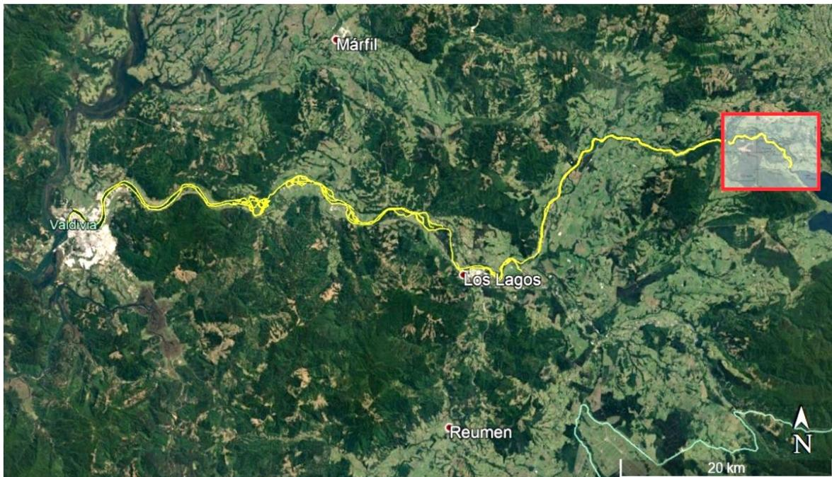
Figura 1.2 Mapa de la zona cercana al deslizamiento (Destacado en el rectángulo rojo), mostrando en amarillo el curso de agua principal que hubiese sido afectado por el rompimiento de la presa por deslizamiento (Fuente: Google Earth y DGA).
