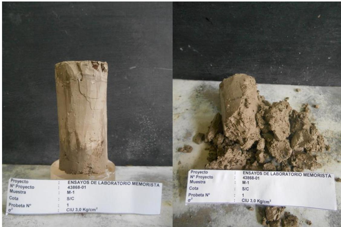
Figura 4.21 Imagen de la muestra antes y después de realizar el ensayo triaxial consolidado - no drenado, con una presión confinante de 3 kg/cm<sup>3</sup>, realizada a una probeta proveniente de la muestra SP1804.
