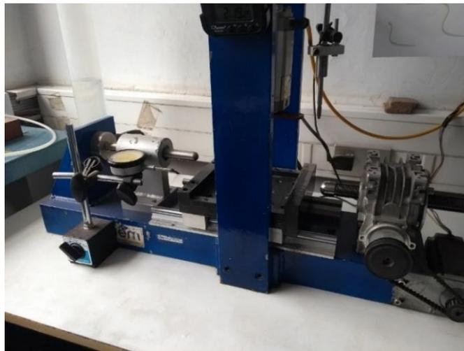
Figura 3.14 Máquina de corte directo; a la derecha se observa el motor que aplica la carga nominal, mientras que la parte central y superior de la imagen se encuentra la máquina que aplica la carga nominal.
