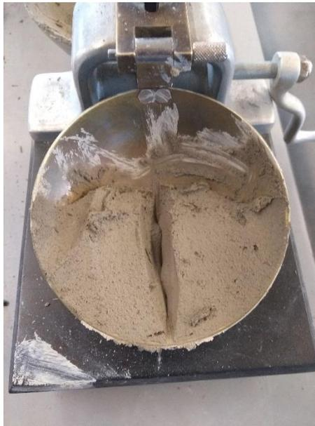
*Figura 3.10 La imagen muestra la división del suelo realizado por el acanalador. Fotografía obtenida al realizar el procedimiento a la muestra SP1803.*
