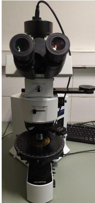
*Figura 3.4 Microscopio petrográfico Olympus BX51.*
