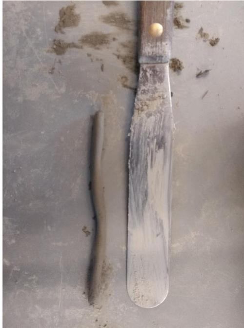
*Figura 3.11 La imagen muestra las dimensiones de un bastoncito usado para definir el límite plástico. Fotografía obtenida al realizar el procedimiento a la muestra SP1803.*
