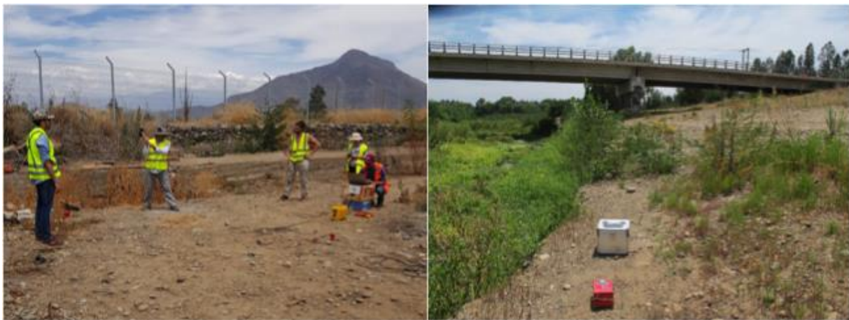
(a) Mediciones de ondas superficiales con método MASW
