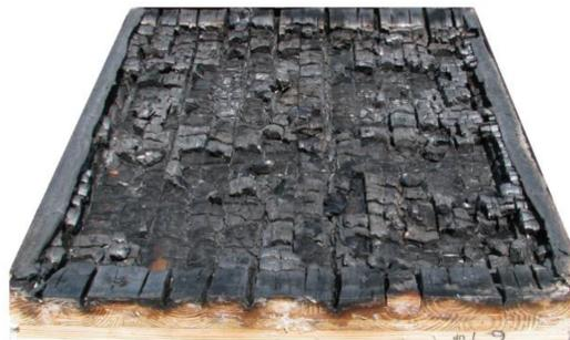
Figura 2.11: *Delaminación* en piso de MCL post ensayo de fuego. Fuente: [Hasburgh et al., 2016].
