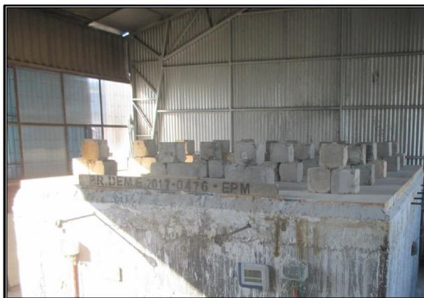
Figura 5.11: Losa de MCL al inicio del ensayo al fuego.
