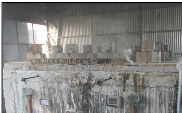
Figura 5.12: Losa de MCL al final del ensayo al fuego.
