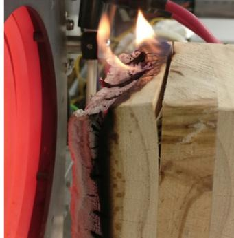
Figura 4.3: Delaminación en MCL de Pino radiata. Fuente: [Emberley et al., 2017a].
