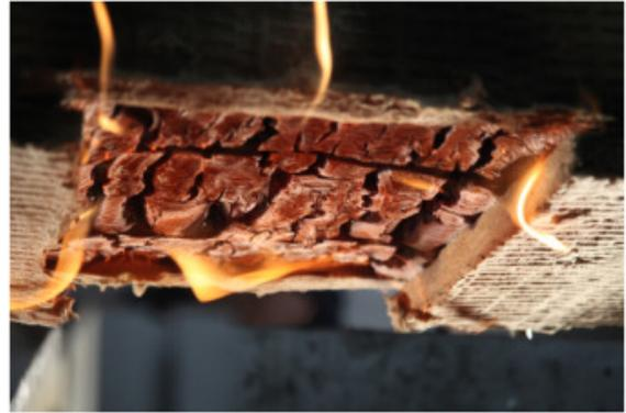
(b) Zona calentada de una viga durante la prueba.
