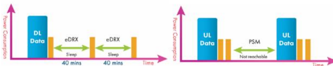
Figura 20 Comparación simple de consumo de potencia entre PSM y eDRX. Fuente: (B. E. Benhiba, 2018)
