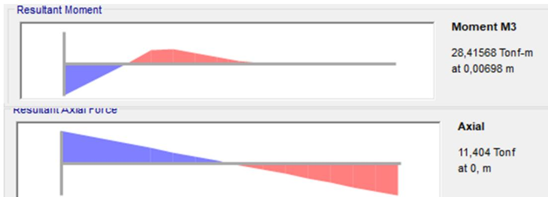
**Figura 63: Resultante de momento y carga axial ante carga lateral. SAP2000**
