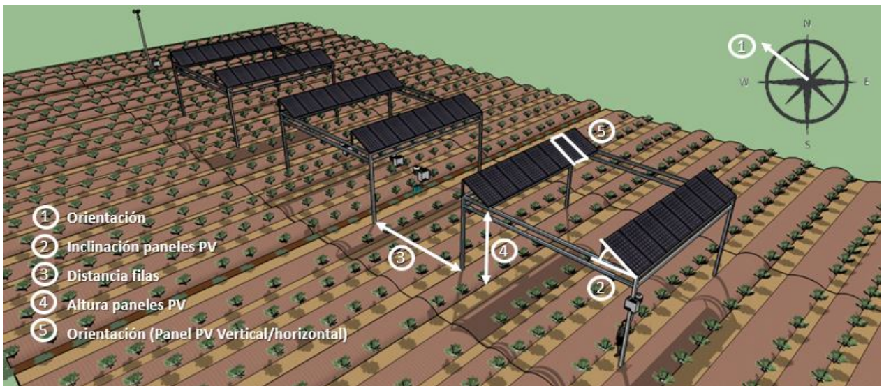
Figura 3.1: Esquema de variables de la configuración de una planta de APV estudiadas.
