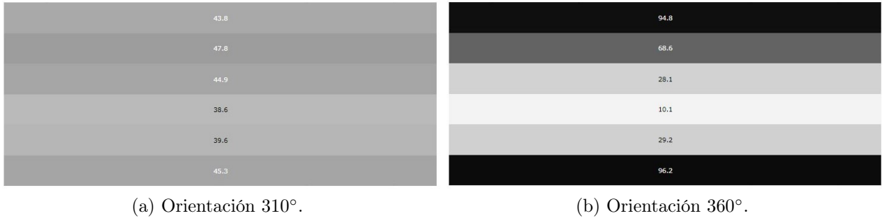
Figura 4.1: Mapas de sombra del promedio anual durante las horas de luz, para elementos de la zona representativa en orientación de 310^\circ con inclinación de 22^\circ y 360^\circ con inclinación de 28^\circ ambas con altura 2,4 m y distancia entre filas de 4 m.
