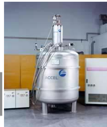
Figura 7: Componentes de un SMES [61] y modelo ACCEL 200 kW, 2 MJ [66].
