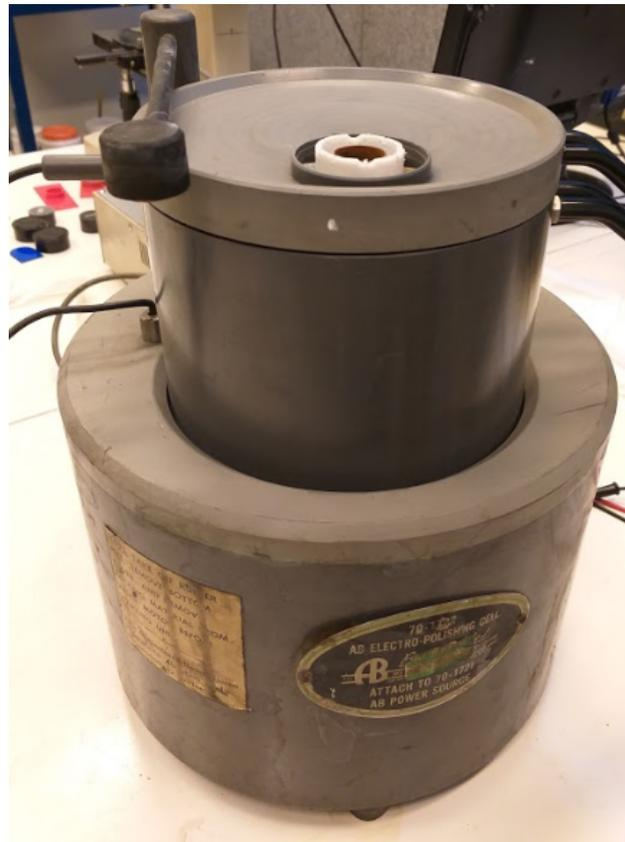
Figura 5.14: Equipo de electropulido Buehler AB Electro-Polishing Cell 1721-2.
