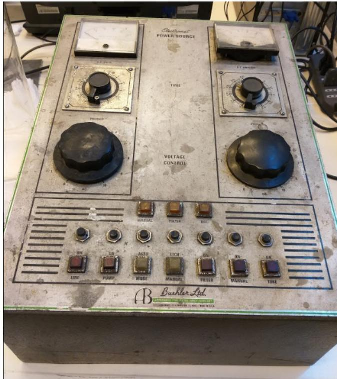
Figura 5.15: Equipo Buehler que controla el movimiento de los imanes dentro de la fuente con el electrolito.
