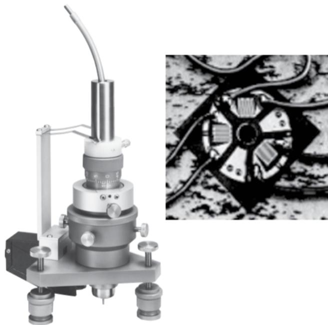
Figura 4.4: Equipo drilling hole modelo RS-200 [4].
