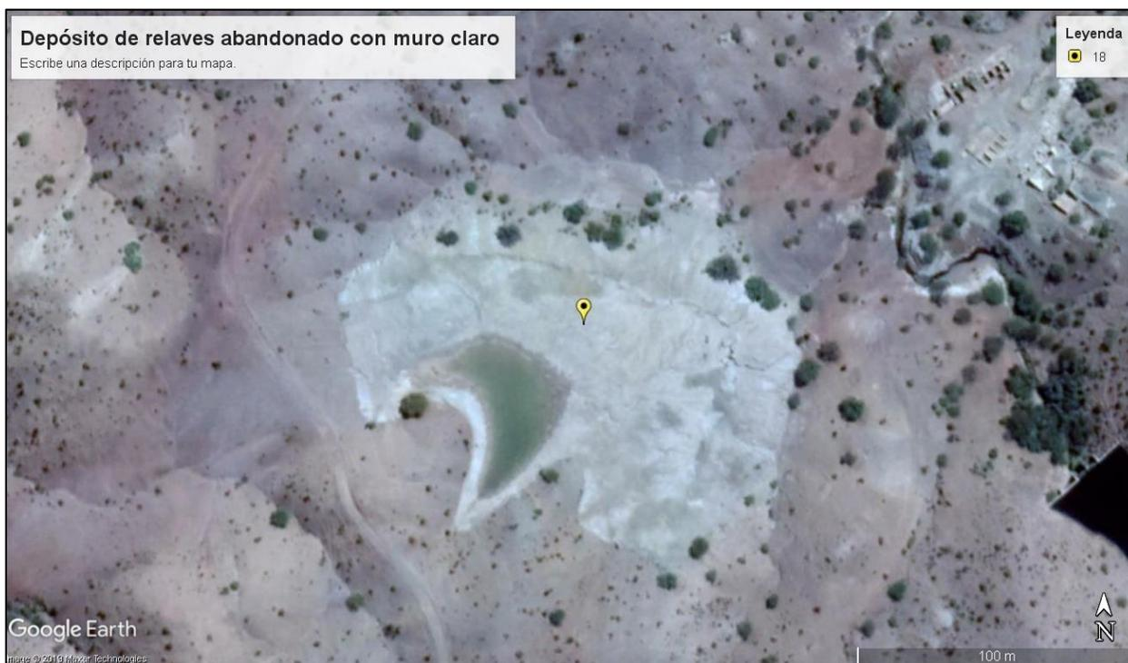
Figura 3.1 Depósito de relaves abandonado (ID 18) con presencia de muro claro y formación de laguna (Google Earth).
