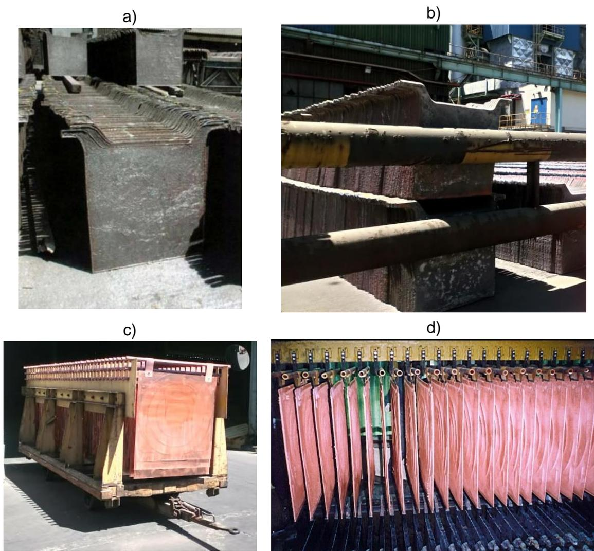
Figura 5: Manejo de ánodos y cátodo en las refinерías a) ánodos acopiados. b) Ánodos acopiados en patio refinерía Ventanas. c) Placas Madre Catódicas ubicadas en Rack, Refinería Ventanas d) Cátodos Saliendo de la celda de electrorefino
