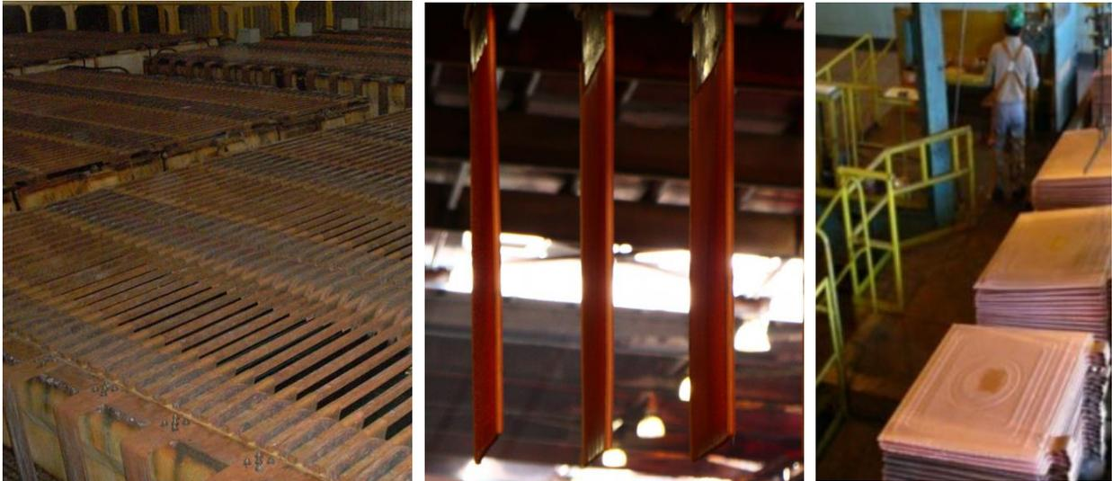
Figura 6: Cosecha de Cátodos de Cobre. a) Celdas de electrorefino cargadas con los electrodos[11]. b) cátodos retirados desde celda de electrorefino[12]. c) Cátodos apilados dentro de las Instalaciones[13]
