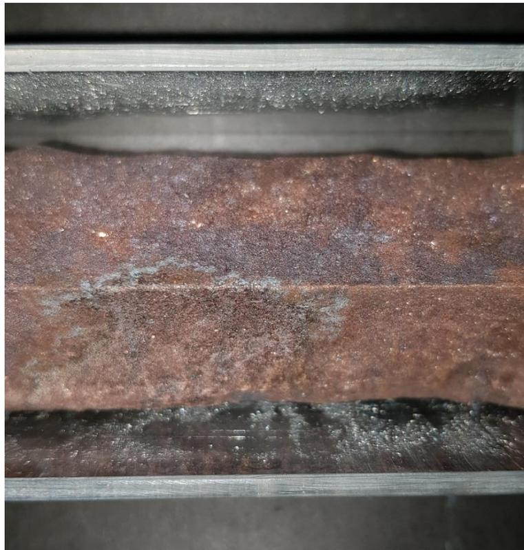
*Figura 52: Microfisuras presentes en el interior del enmascarado.*
