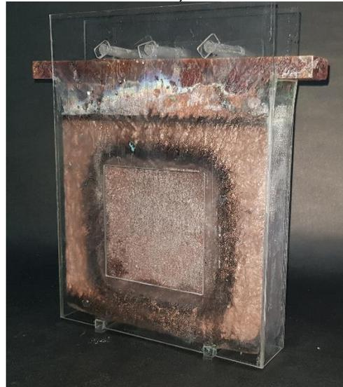
Figura 33: Avance de la ventana en el ánodo, 312 horas de proceso. se aprecia una marcada formación de la ventana que sigue la forma de la apertura en el enmascaramiento a) ánodo sin enmascarar b) ánodo enmascarado
