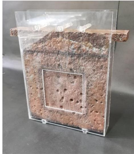
Figura 32: Progresión de la disolución selectiva de la ventana del ánodo a las 168 horas del proceso. a) ánodo con enmascaramiento b) ánodo enmascarado cara posterior
