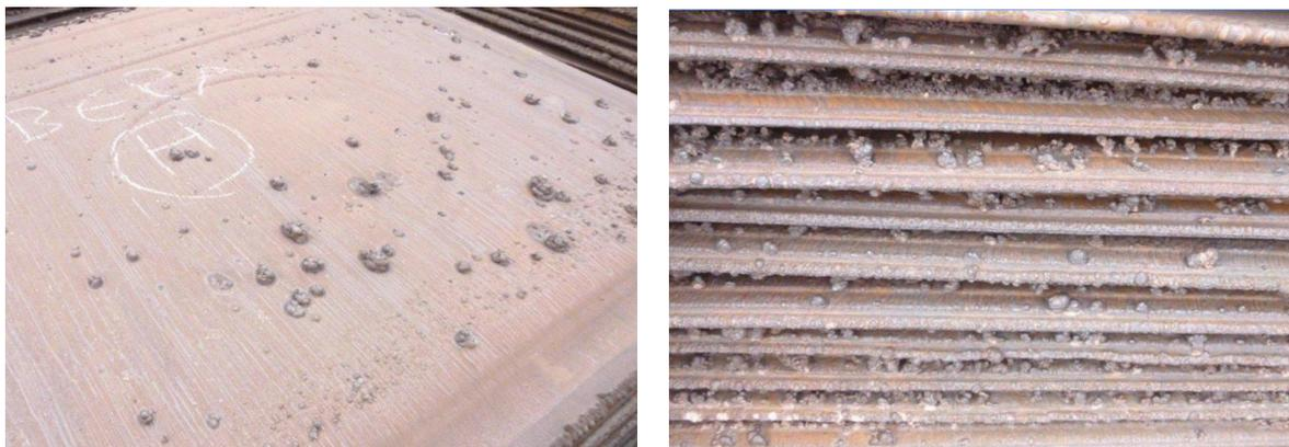
Figura 9: Nodulación en cátodos industriales[11]
