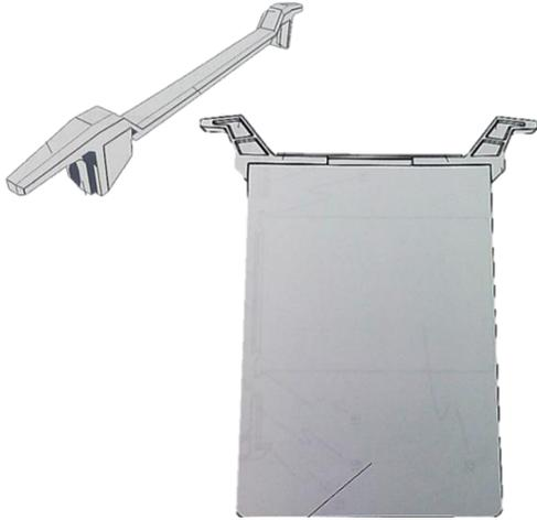
Figura 10: Medio colgador y ánodo de geometría optimizada propuesto en patente industrial 2307-11[17]
