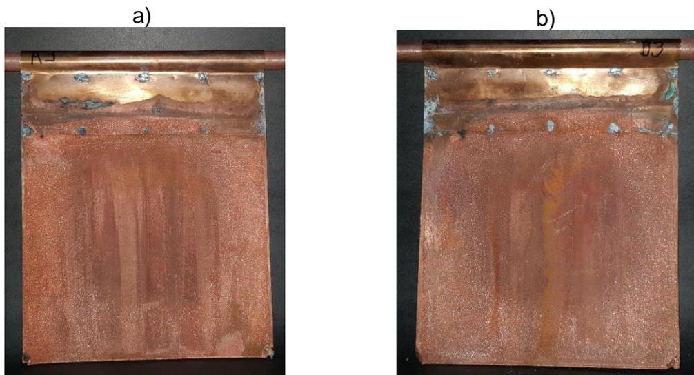
Figura 42: Cátodos correspondientes a la cosecha de las 384 horas. a) Cátodo A b) Cátodo B
