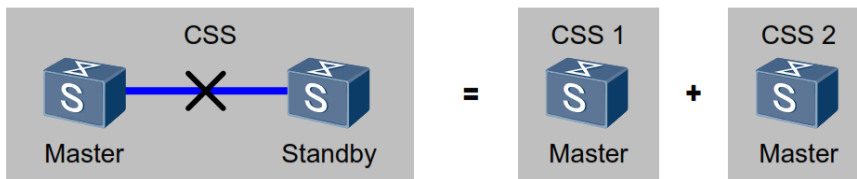
Figura 2-57 Ejemplo de falla de conexión CSS. [18]
