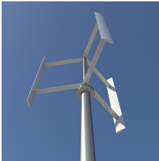
Figura 1.5: Turbina H-Darrieus (Rotor-H) de 3 álabes.
