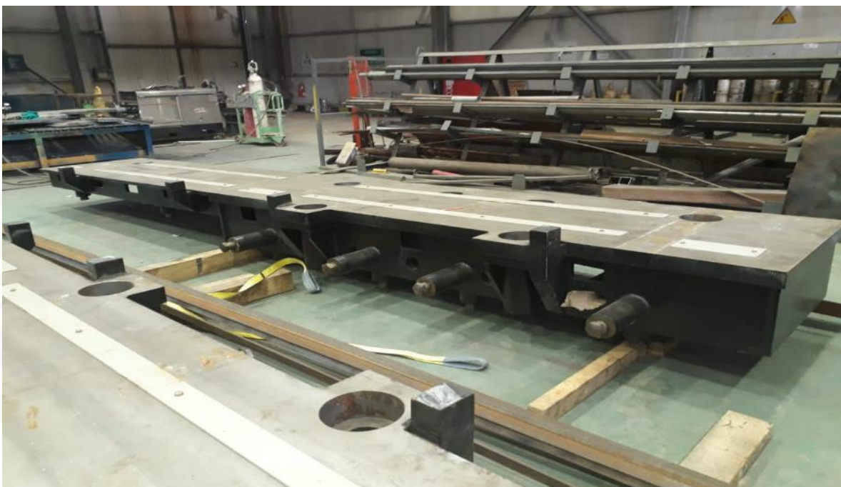
Figura A.5 Retiro de Soleplate en bodega y fabricación de piezas especiales
