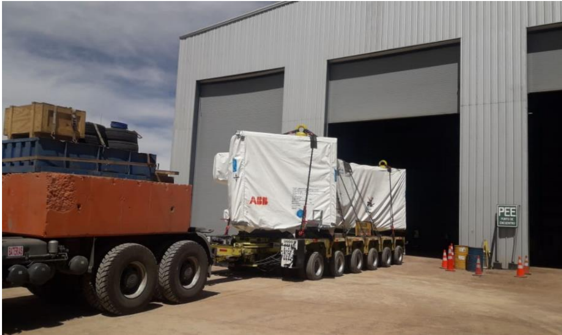
Figura A.2 Traslado de cuarto del estator, desde Iquique a bodega CMDIC
