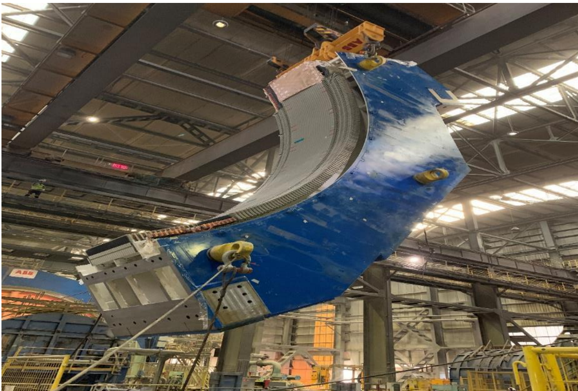
Figura A.21 Izaje y montaje de Cuartos de Estator.
