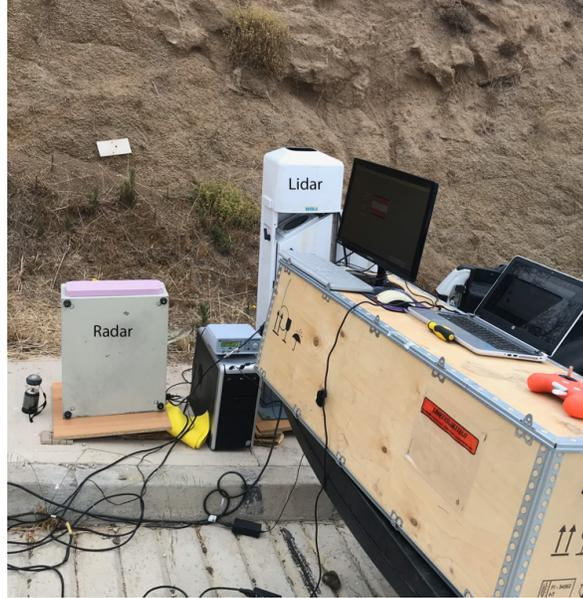
**Figura 5.5:** Configuración experimental. Los instrumentos fueron nivelados utilizando un medidor de nivel de agua y las tablas que se ven bajo los instrumentos.
