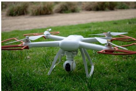
**Figura 5.1:** *Xiaomi Mi Drone* es el aeronave utilizada como objetivo de prueba. El exterior es plástico y sus dimensiones son 37 x 47 x 17 cm.
