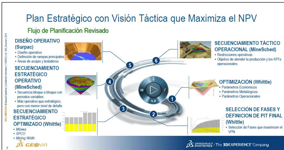
Figura 2: Esquema de funcionamiento del software Whittle-Milawa y herramientas complementarias, a partir del uso del algoritmo de L&G. (Saravia, 2015).
