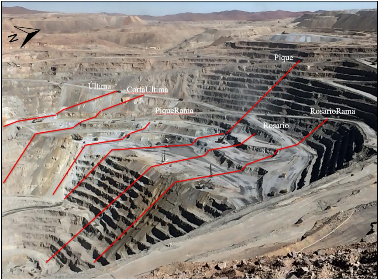
Figura 3.8 Avance de mina con vista en dirección hacia el SW. La delimitación de las fallas dentro de la mina es realizada de acuerdo a evidencias de planos con trituramiento y argilización intensa en la zona de falla, con un consecuente deslizamiento en el bloque colgante. Su continuación puede ser interpretada con datos en profundidad de cortes diamantino, a relaciones de desplazamiento en las litologías reconocidas y a lineamientos preferenciales de algunos metales de importancia.
