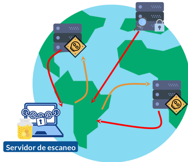
Figura 1.2: En el escaneo pasivo, una máquina recibe todos los paquetes enviados por investigadores o agentes maliciosos hacia una subred en específico (flechas rojas), pudiendo o no responderlos según el tipo de configuración (flechas naranjas). Estos paquetes se almacenan para su posterior análisis.
