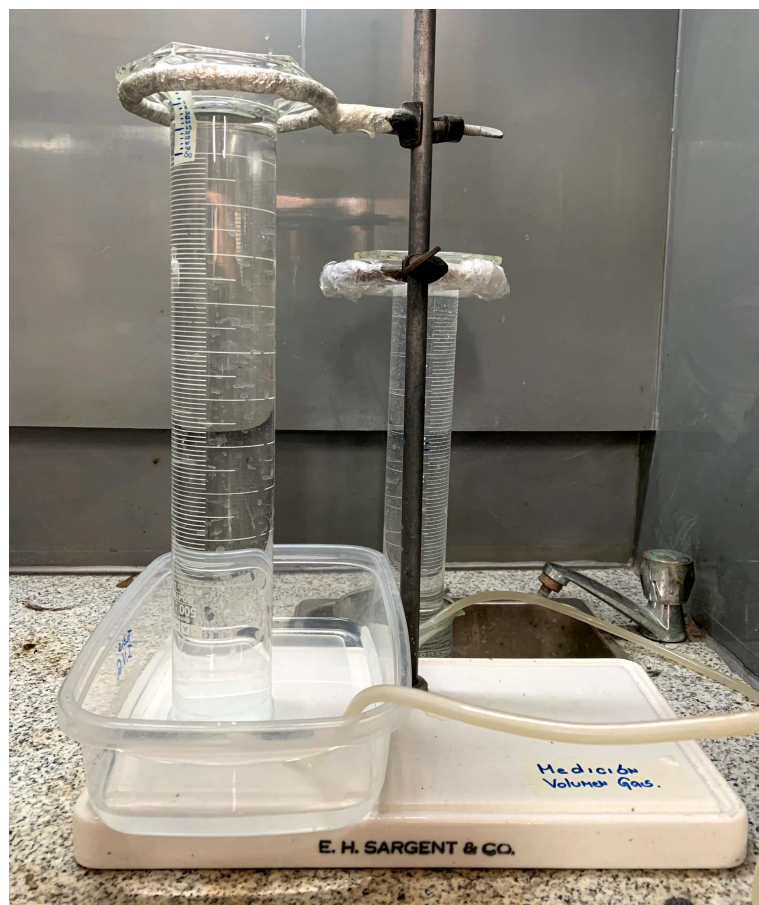
Figura B.2: Montaje del sistema de medición de biogás producido
