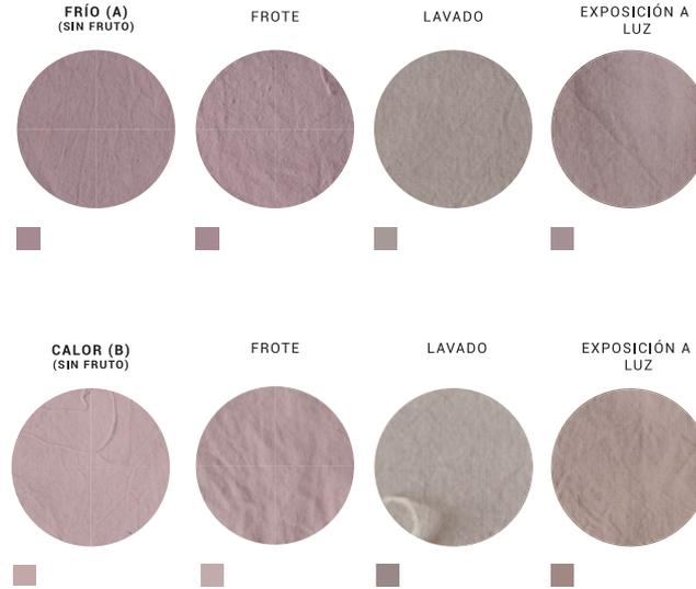
Fig. 34 Resultados muestras: pruebas de resistencias.
