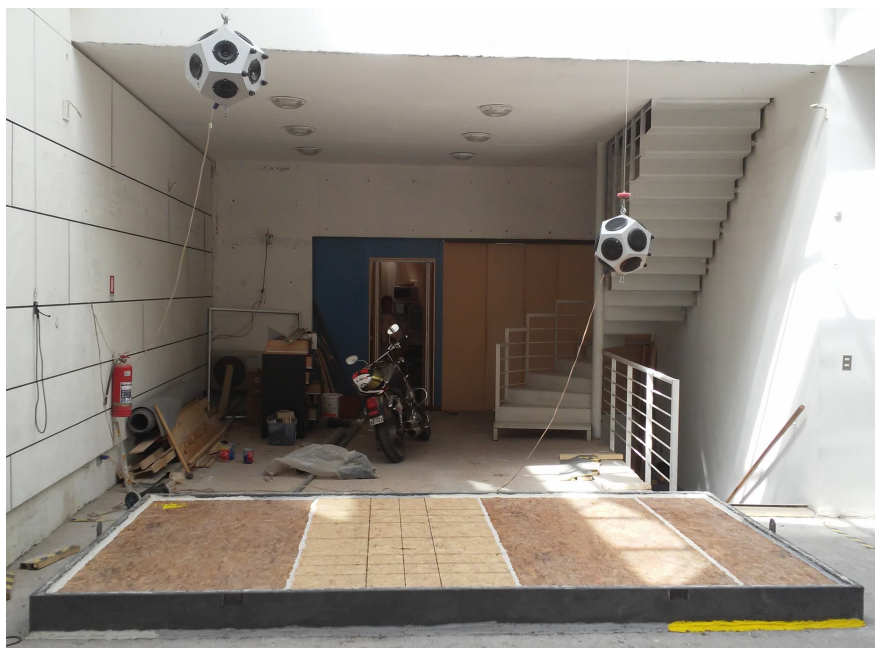
Figura 5.12: Fuentes de sonido ensayo ruido aéreo
