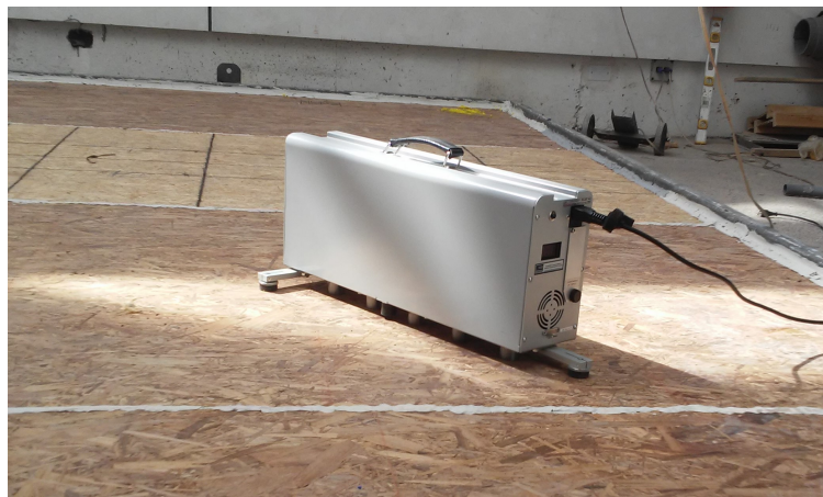
Figura 5.14: Fuente de impactos en ensayo de impacto
