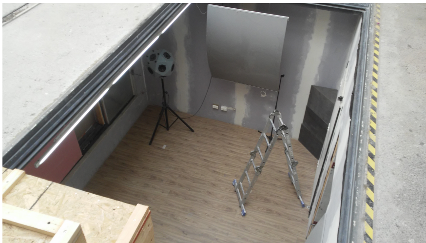
Figura 5.8: Sala receptora y marco para la probeta
