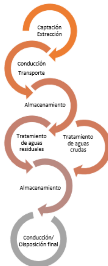
Esquema 1 Circuito común de plantas de Tratamiento Fuente: Elaboración propia en base a Conagua, 2010.
