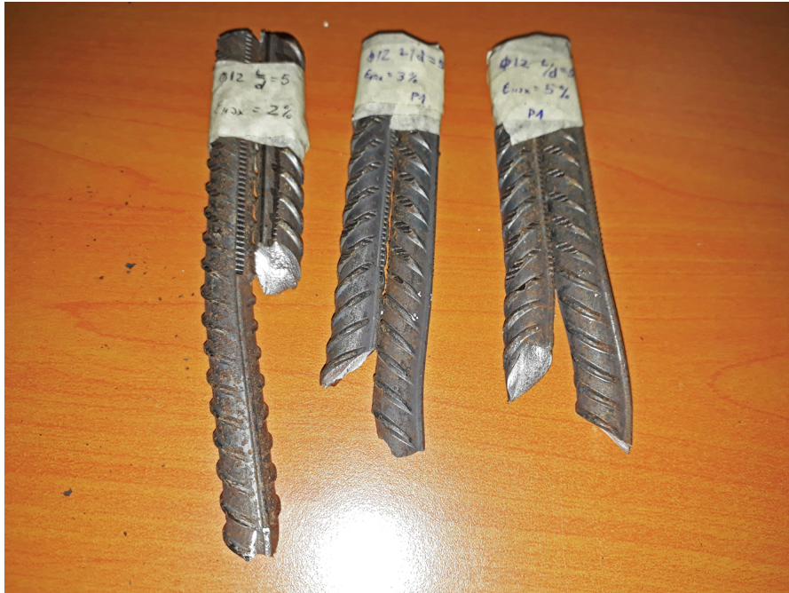
Figura 80: Probetas \phi 12 L/d = 5 ensayadas a la rotura.
