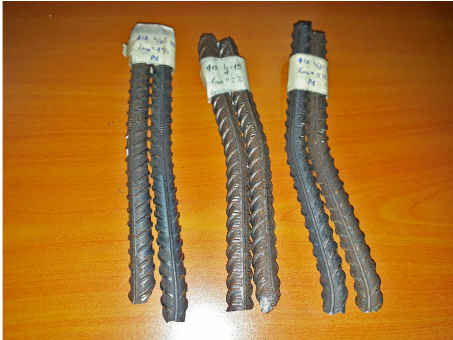
Figura 82: Probetas \phi 12 L/d = 15 ensayadas a la rotura.
