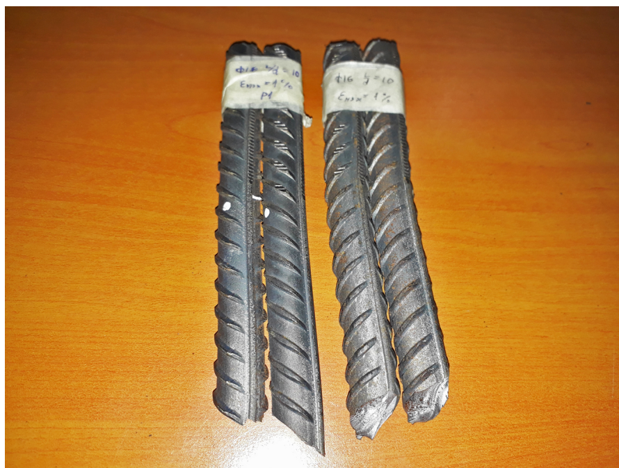
Figura 85: Probetas \phi 16 L/d = 15 ensayadas a la rotura.
