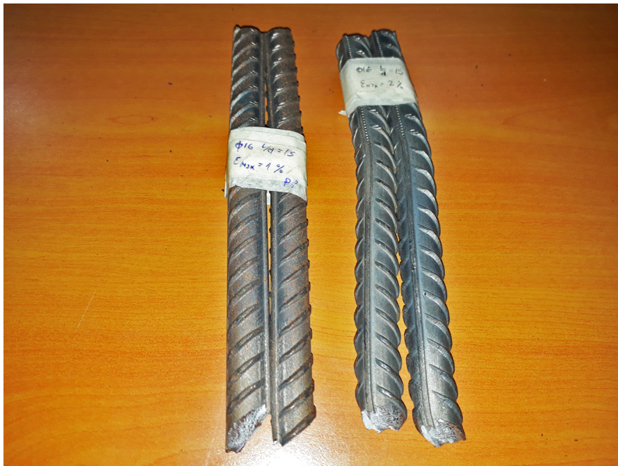
Figura 83: Probetas \phi 16 L/d = 5 ensayadas a la rotura.
