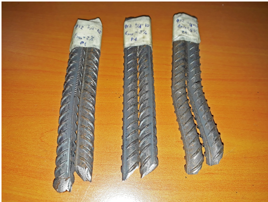
Figura 81: Probetas \phi 12 L/d = 10 ensayadas a la rotura.
