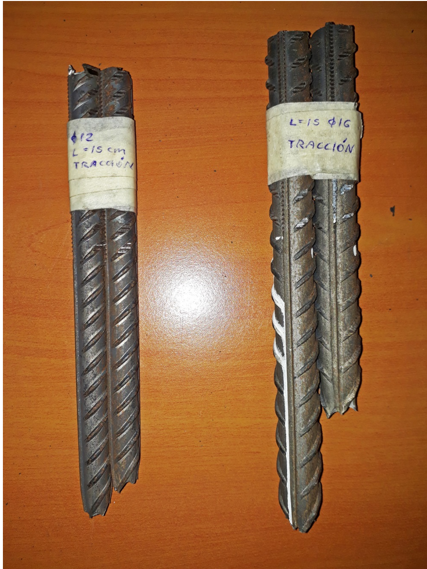
Figura 79: Probetas \phi 12 y \phi 16 ensayadas a tracción.
