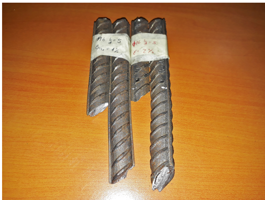
Figura 84: Probetas \phi 16 L/d = 10 ensayadas a la rotura.
