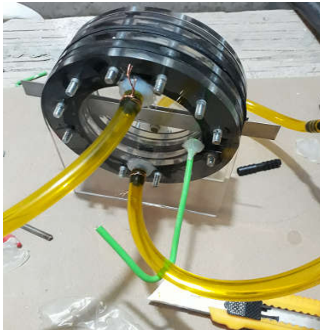
Figura 7. Una de las celdas diseñada y construida, pero desechada debido a que el cambio de electrodos era demasiado lento.
