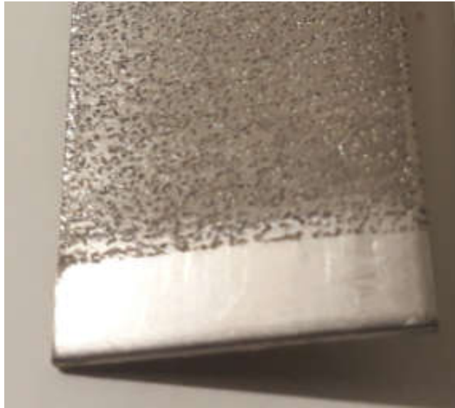
Figura 31. Cráteres formados por corrosión en ánodos del electrolizador
