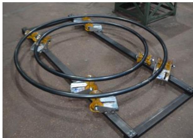
Figura 4-30: Anillos para rotación montados sobre base con rodillos. Elaboración Propia.
