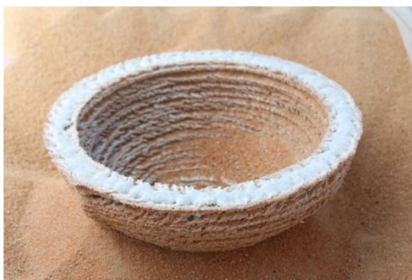
Figura 1-1: Modelo sólido obtenido mediante impresión 3D con lente de Fresnel. [1]
