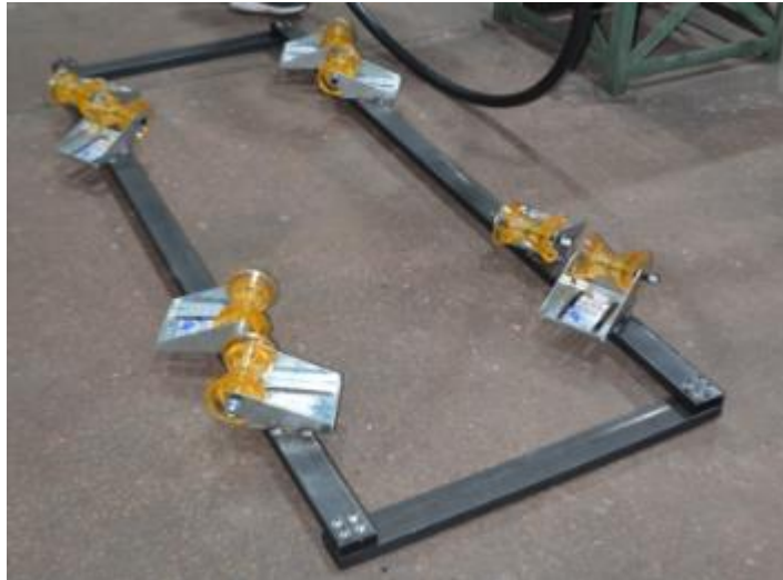
Figura 4-29: Base del sistema con brackets de rodillos soldados.
