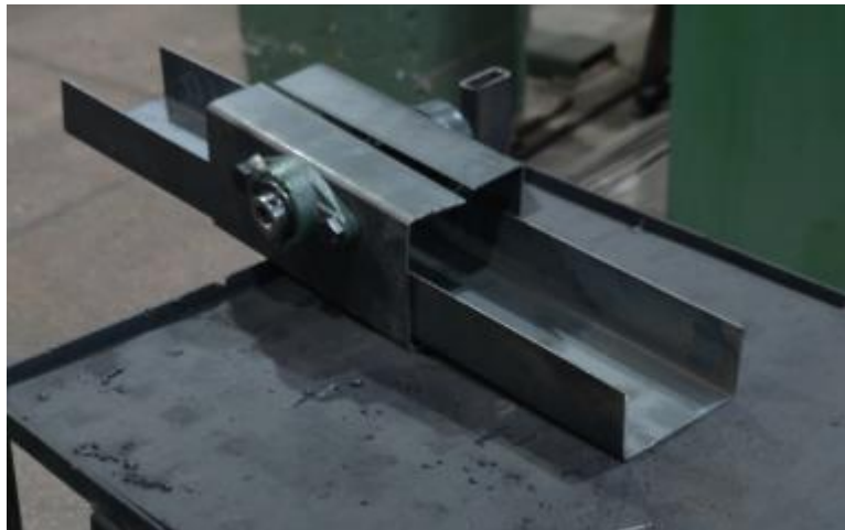
Figura 4-32: Soporte para subsistema de rotación. Elaboración propia.
