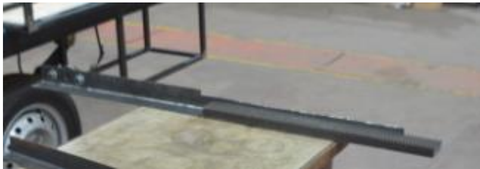
Figura 4-39: Union soldada perfil-cremallera. Elaoración propia.
