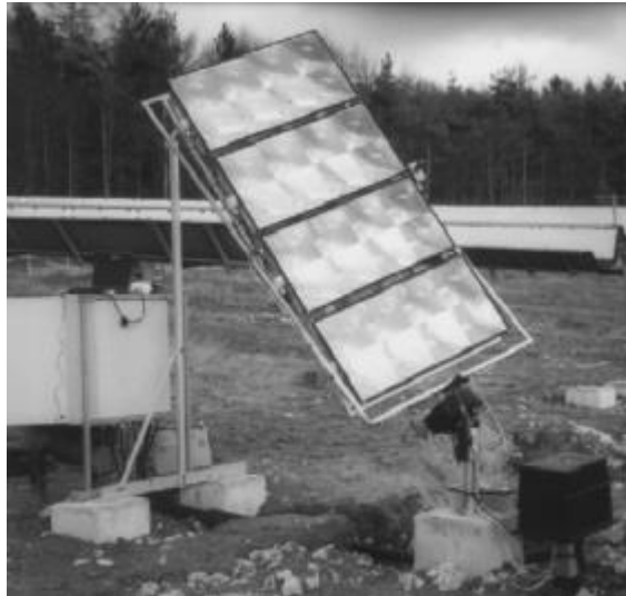
Figura 3-3: Arreglo de lentes de Fresnel con sistema de gimbal [1].
