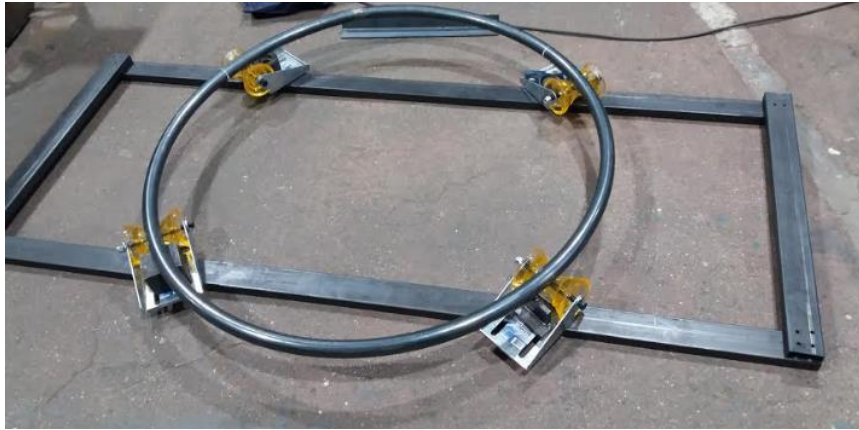
Figura 4-21: Fotografía del mecanismo de la base en construcción.
