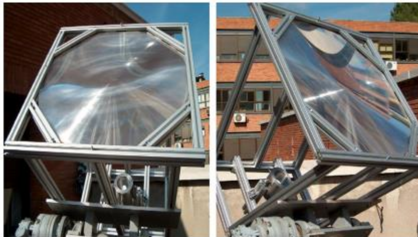
Figura 3-4: Montaje de lente de Fresnel enmarcado [1].
