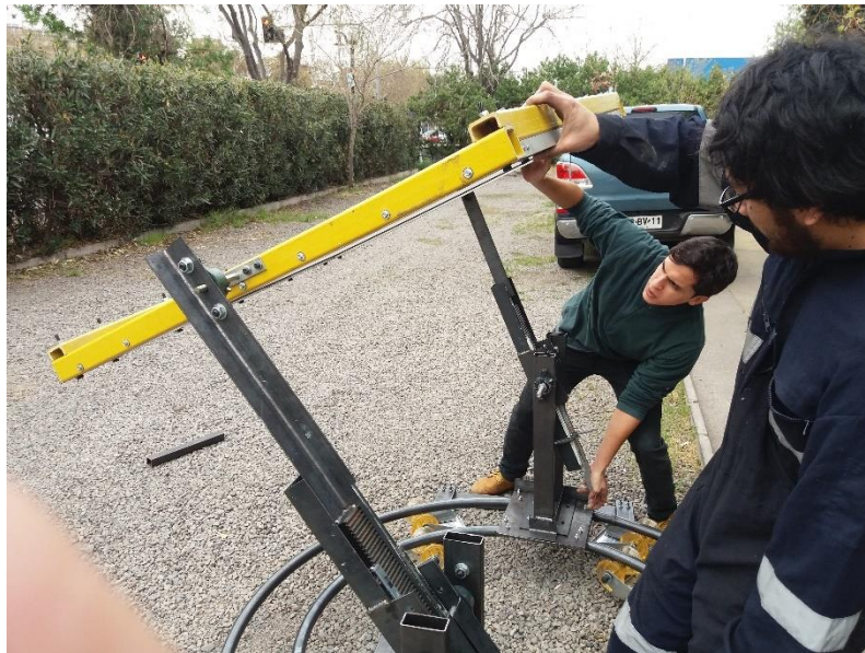
Figura 4-44: Manipulación del mecanismo para ajuste del punto focal. Fuente: Elaboración propia.
