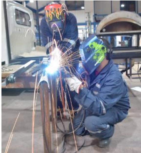
Figura 4-38: Soldadura MIG. Fuente: Elaboración Propia.
