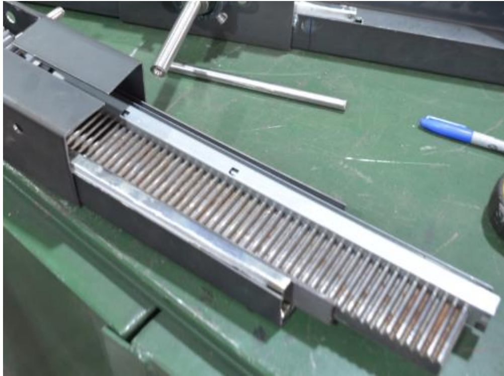
Figura 4-35: Cremalleras instaladas antes de aplicar soldadura. Elaboración propia.
