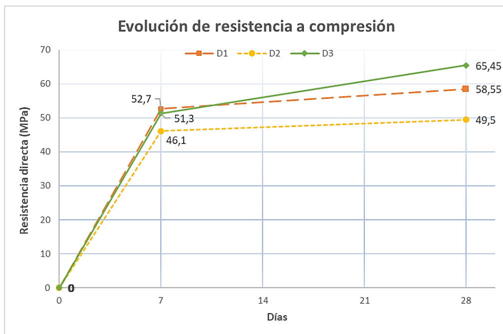
Figura 4.3: Evolución de resistencia a compresión de probetas de ensayo. Fuente: (Elaboración propia en base a informe Geholab)
