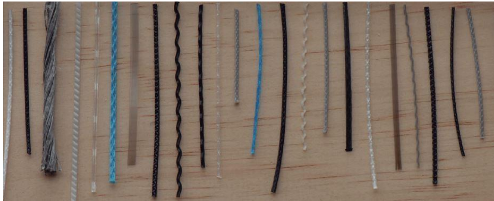
Figura 2.4: Distintas formas y relieves de las fibras de polipropileno. Fuente: (CTES, 2015)
