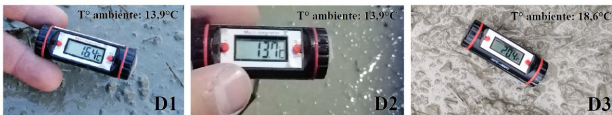
Figura 4.1: Registro de temperatura del hormigón y temperatura ambiente. Fuente: (Elaboración propia)
