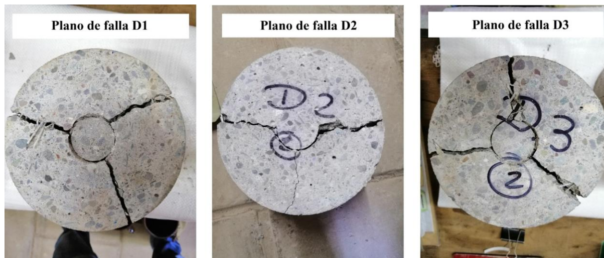
Figura 4.19: Patrones de falla en probetas D1, D2 y D3. Fuente: (Elaboración propia)
