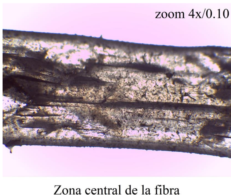
Figura 4.12: Fotografía en microscopio con lente Leica Plan 4x/0.10 de fibra Barchip54 recuperada. Fuente: (Elaboración propia)
