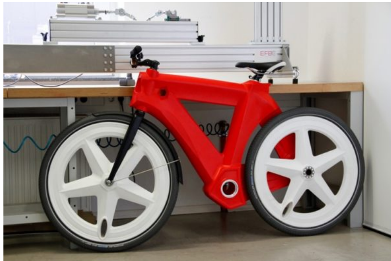
Figura 2.21: Bicicleta echa de plástico reciclado de la marca DutchFiets
