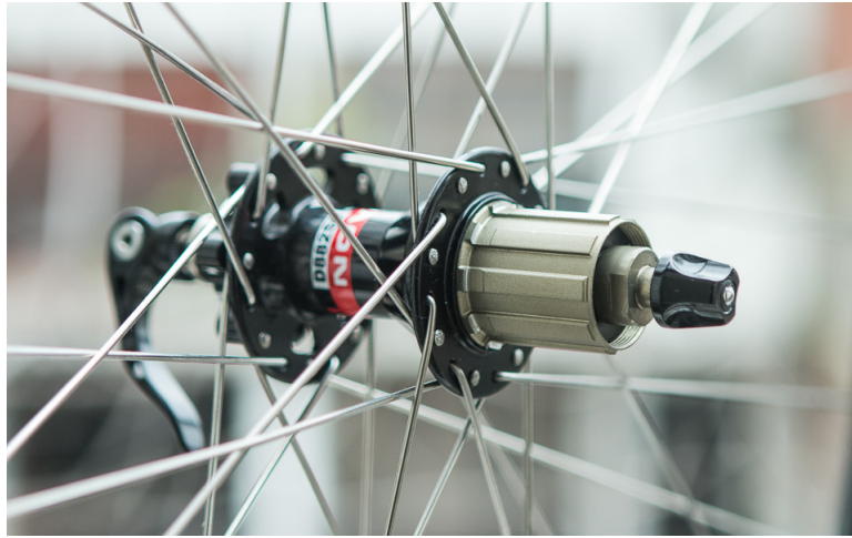
Figura 2.38: Rayos de una rueda dispuestos de forma cruzada
