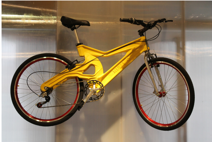
Figura 2.20: Bicicleta echa de plástico reciclado de la marca Muzzicycles
