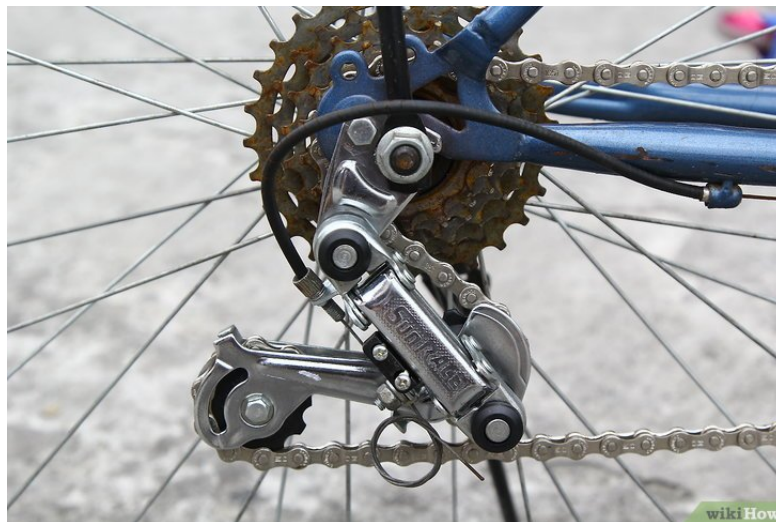
Figura 2.35: Desviador trasero de una bicicleta
