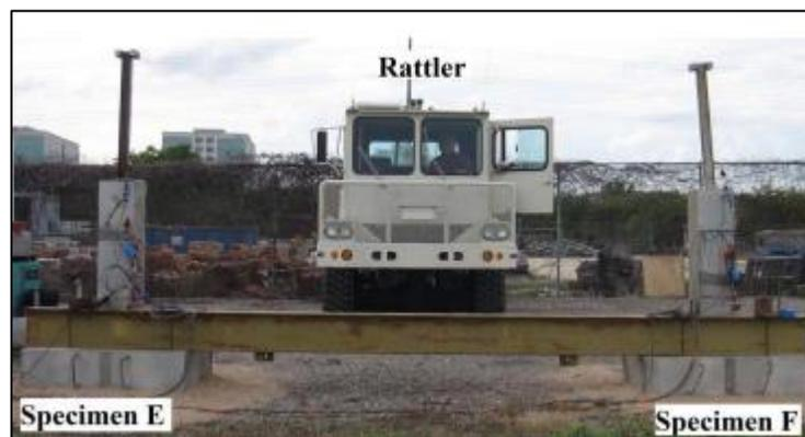
Figura 2.15 Montaje experimental para Ondas-S (Yan, 2015).
