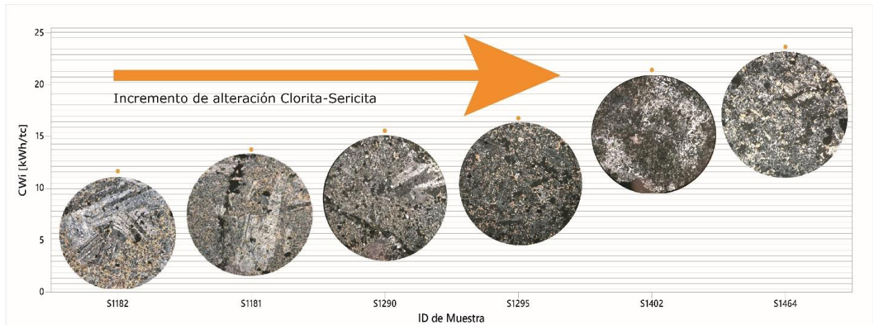
Figura 6.1 Gráfico que relaciona el comportamiento de Cwi con la textura de alteración de distintas muestras estudiadas en microscopio para la unidad litológica CMET.
