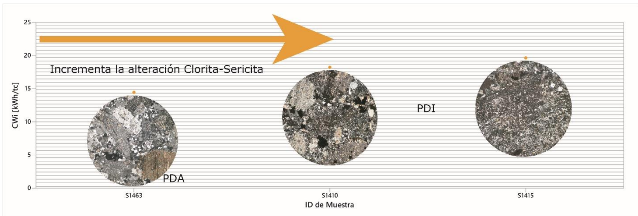
Figura 6.2 Gráfico que relaciona el comportamiento de Cwi con la textura de alteración de distintas muestras estudiadas en microscopio para unidades de pórfidos félsicos.
