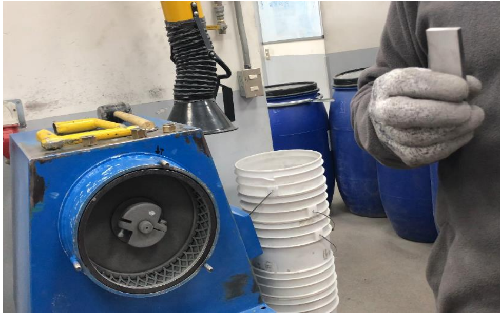
Figura 1.7 Máquina para realizar el test de abrasión de Bond. En la mano del operador se encuentra la placa de un acero que simula el recubrimiento de los chancadores.
