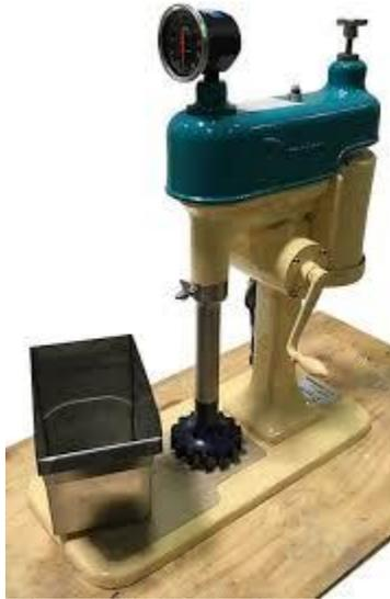
**Figura 7 Máquina de flotación de laboratorio Denver Metso D-12**
