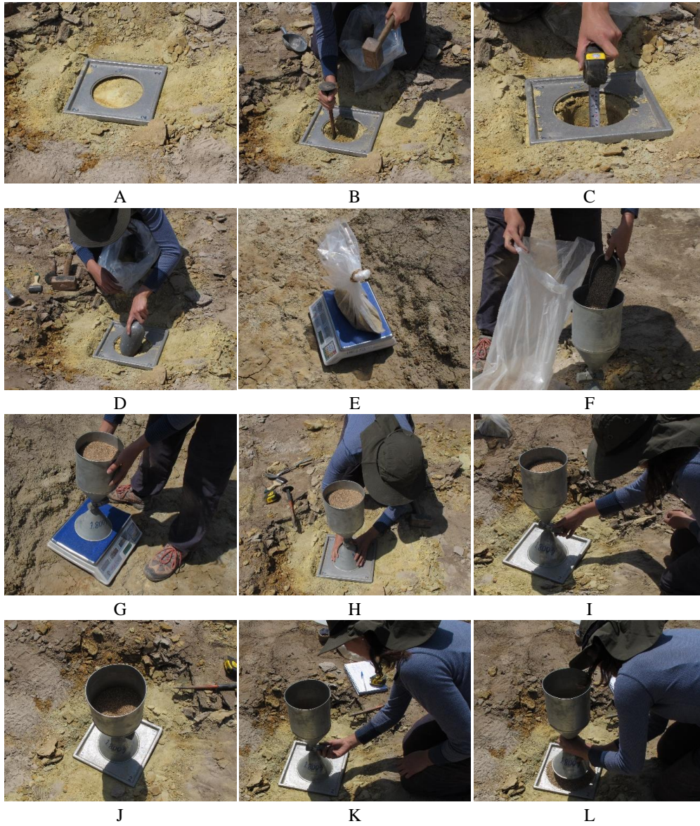
Figura D - 1: Metodología en terreno cono de arena.
