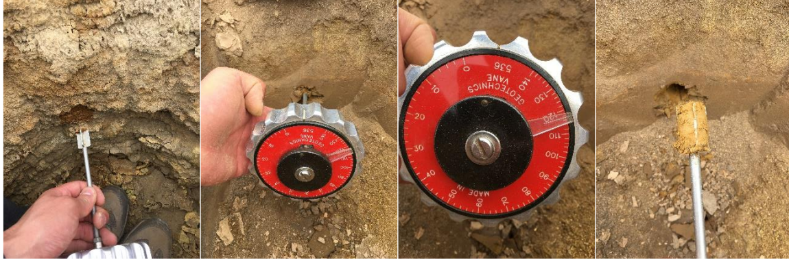
Figura 4-5: Procedimiento para el uso de veleta.
