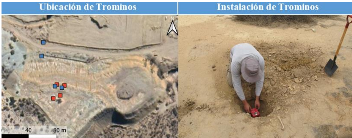
Figura 4-6: Ubicación e instalación de Trominos, Depósito A.
