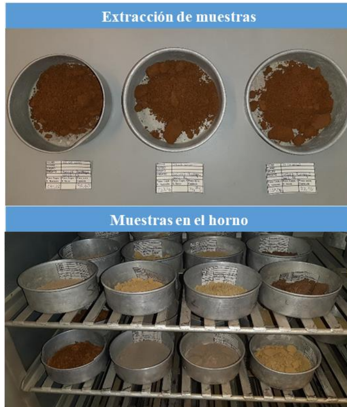
Figura 4-7: Parte del proceso de medición del contenido de humedad.
